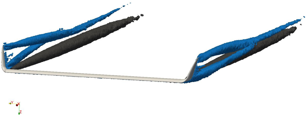
Slika 20. Prikaz kontura veličine Q = 10 \text{ s}^{-2} , za obje geometrije
