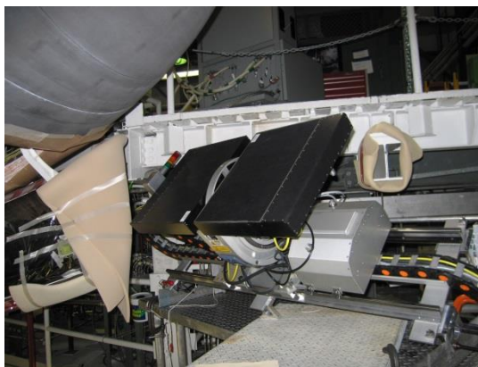
Slika 4.1. Uređaj za rendgensko snimanje tehnikom raspršenog zračenja [8]
