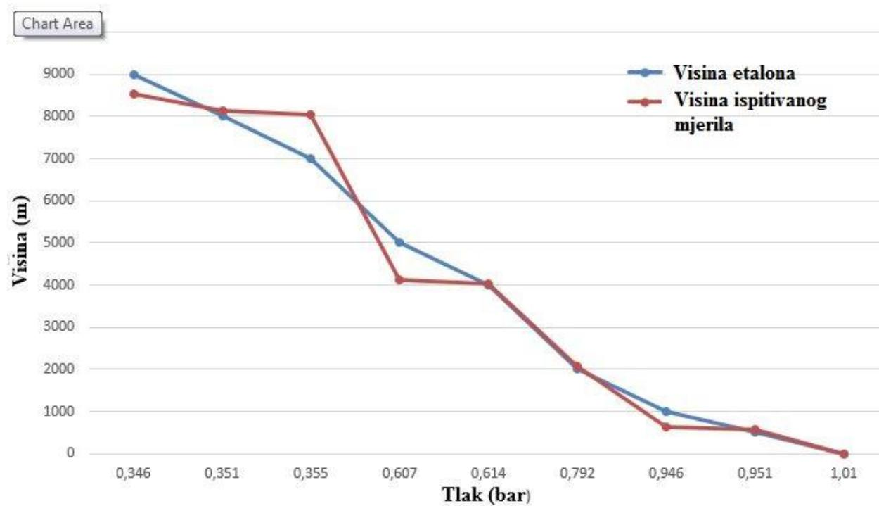
Slika 12. Prikaz razlike ispitivanog mjerila i etalona
