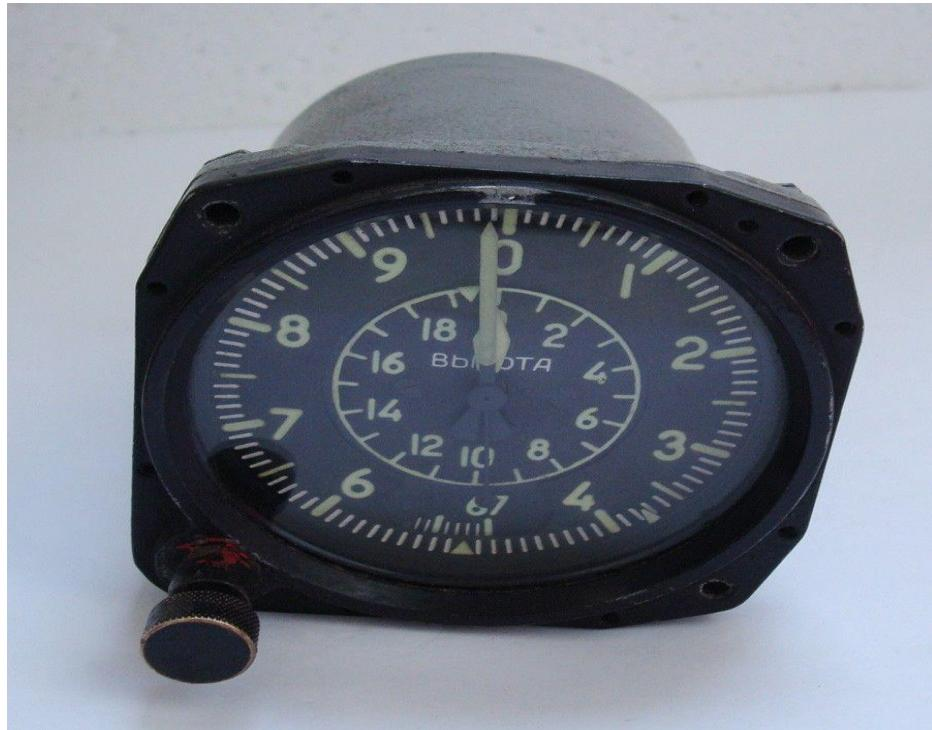
Slika 2. Barometarski visinomjer s podjelom u metrima
