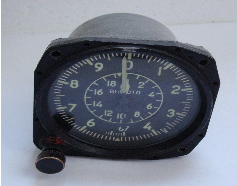
Slika 2. Barometarski visinomjer s podjelom u metrima
