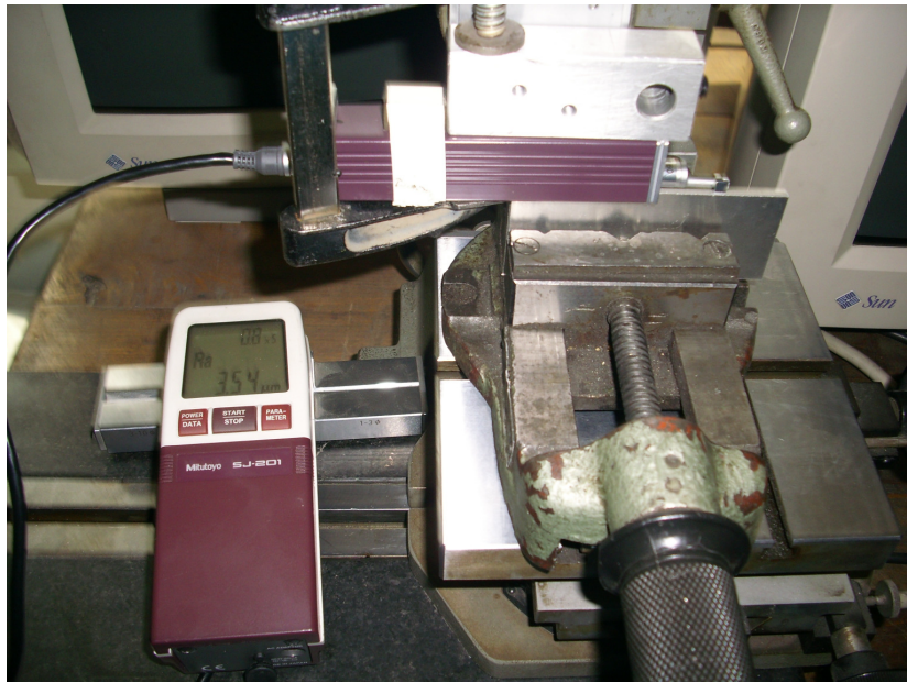
Slika 2.16 Prikaz mjerenja hrapavosti laserskih uzoraka
