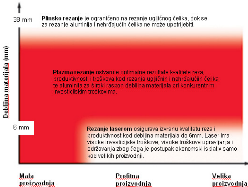
Slika 2.25 Dijagram analize plazma, plinskog i laserskog rezanja s obzirom na produktivnost i debljinu materijala [14]
