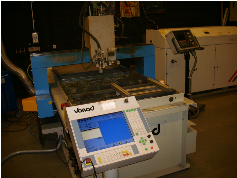
Slika 2.1 Prikaz upravljačke jedinice i CNC stola za plazma rezanje
