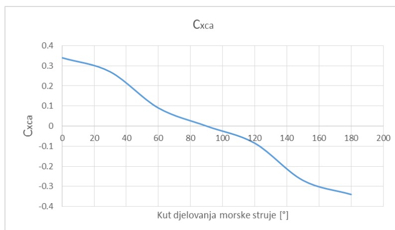
Slika 6.4. Koeficijent C_{xca} u odnosu na kut djelovanja morske struje [10]
