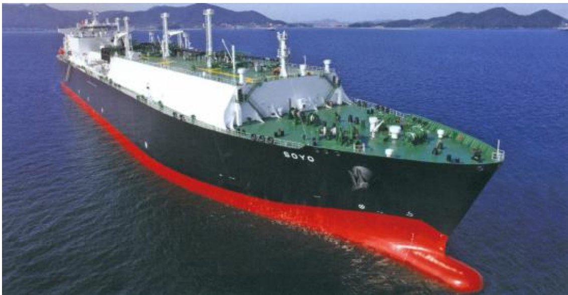
Slika 2.2. LNG brod sa membranskim spremnicima
