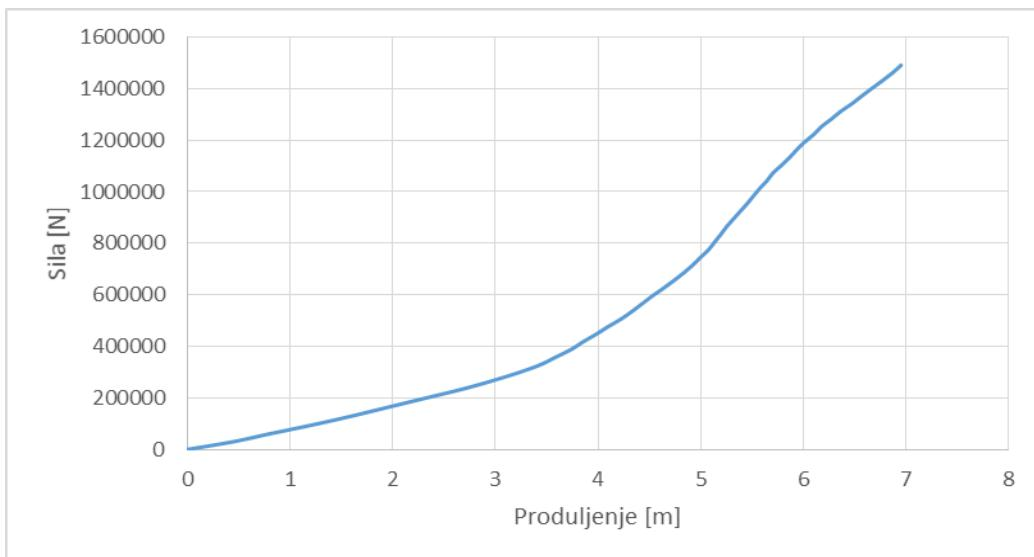
Slika 8.12. Ovisnost sile o produljenu najlonskog konopa
