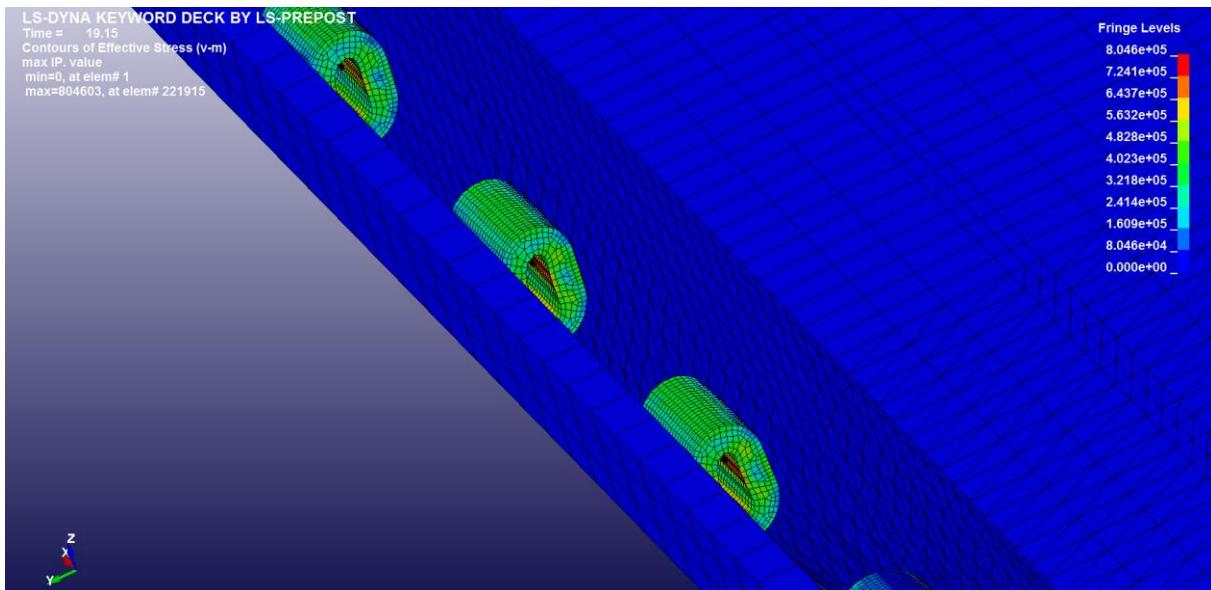
Slika 9.2. Von Mises naprezanja krmenih odbojnika
