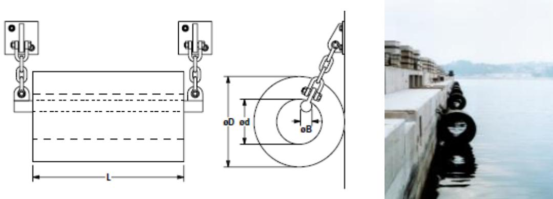
Slika 8.4. Gumeni cilindrični odbojnik [14]
