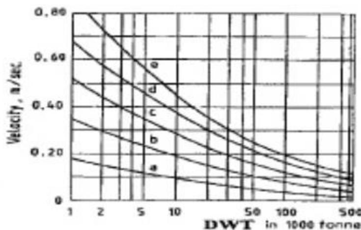
Slika 7.3. Određivanje brzine prilaženja [13]
