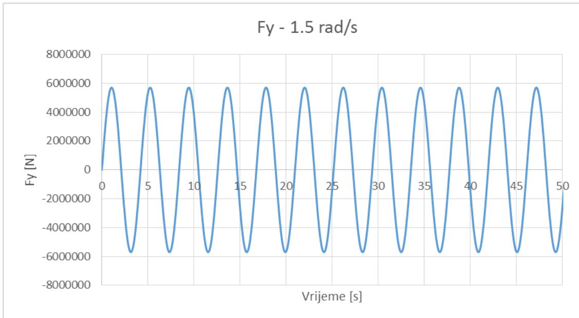
Slika 9.1. Komponenta uzbudne sile u poprečnom smjeru
