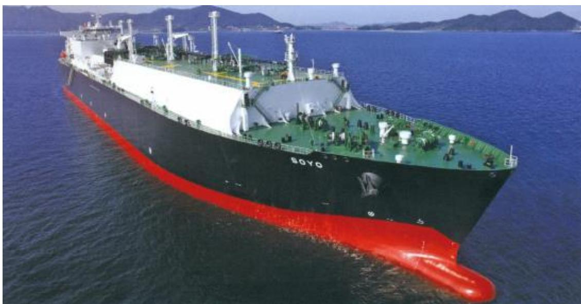
Slika 2.2. LNG brod sa membranskim spremnicima
