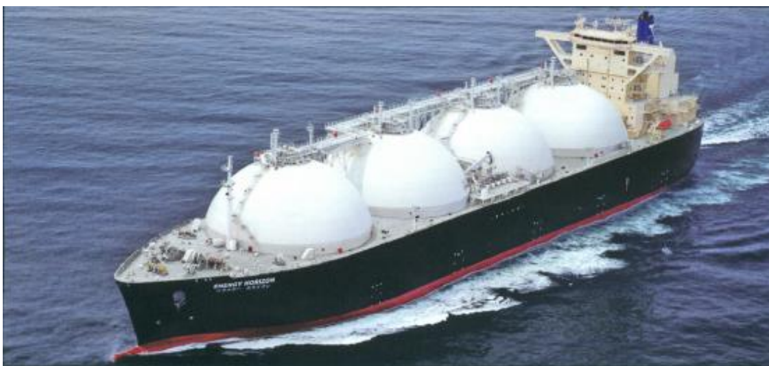
Slika 2.1. LNG brod sa sfernim tankovima
