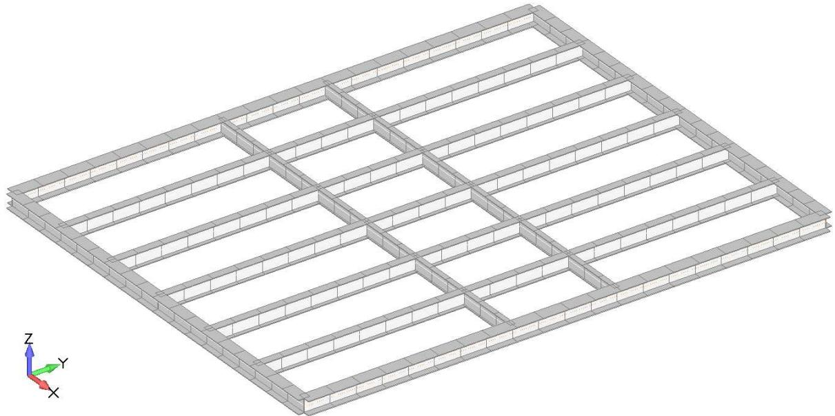
**Slika 20.** Gredni model roštilja kompozitne palube V1
