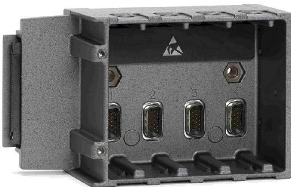
Slika 8. Izmjenjivo FPGA postolje CompactRIO mjerne stanice [4]
