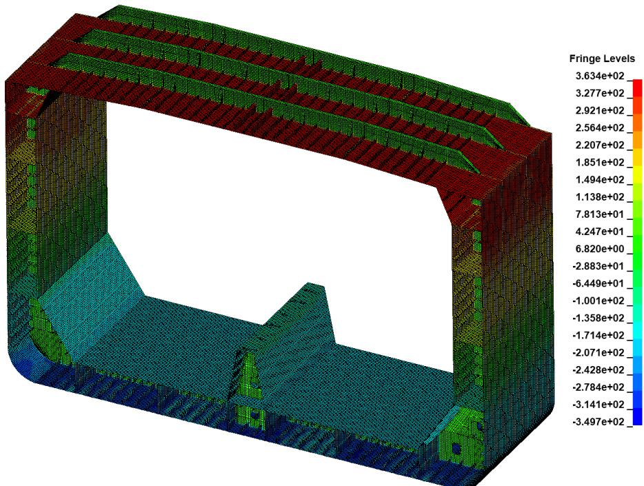
Slika 61 Naprezanja u smjeru osi x za  $M_{ULT}$
