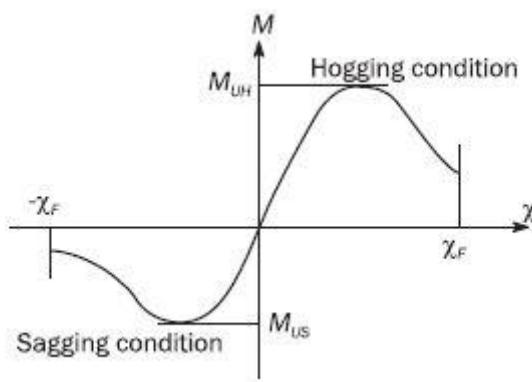
Slika 4 Granični moment savijanja u ovisnosti o zakrivljenosti [3]
