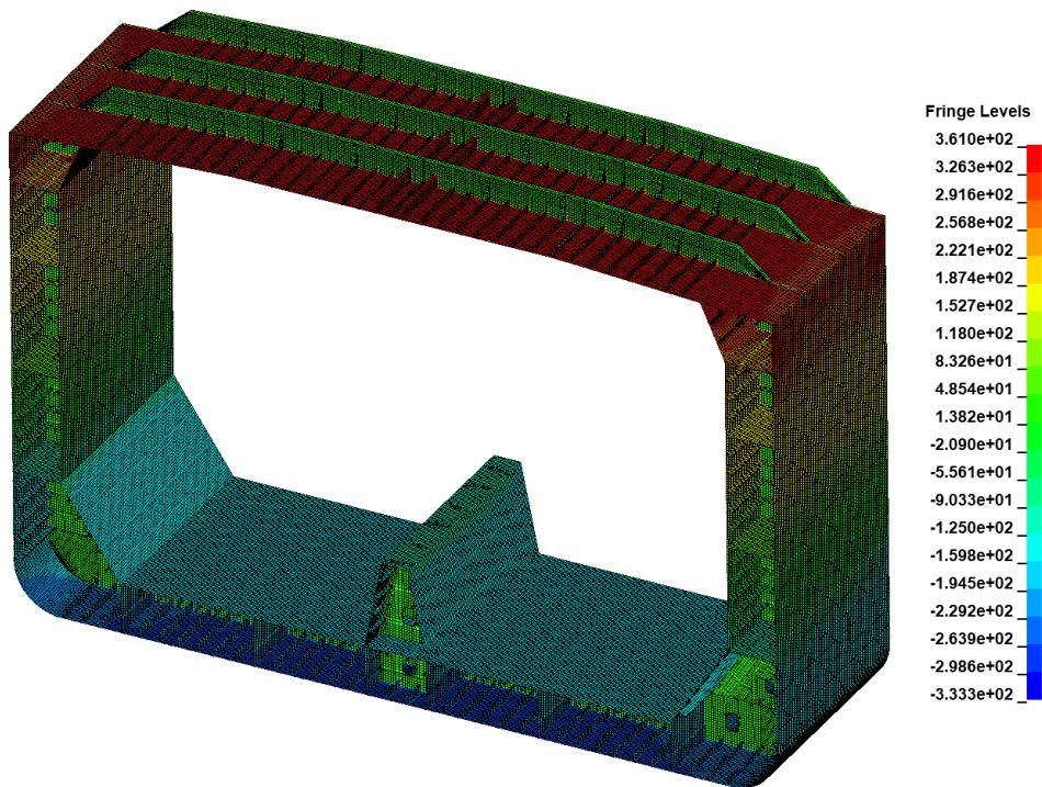
Slika 60 Naprezanja u smjeru osi x za  $0,8M_{ULT}$
