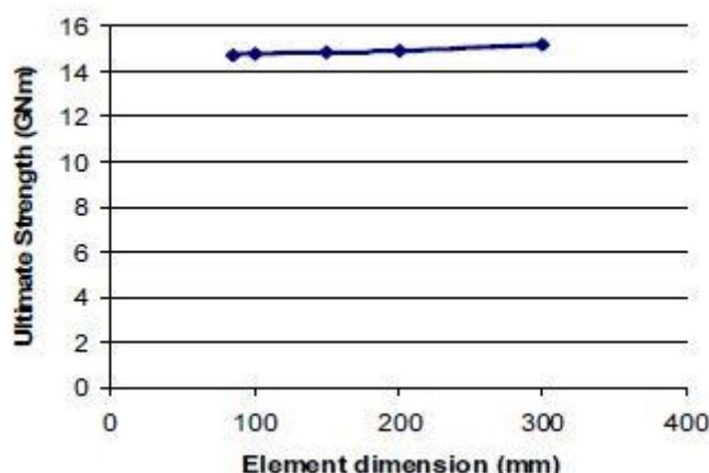
Slika 10 Ovisnost graničnog momenta savijanja o dimenziji elementa [9]
