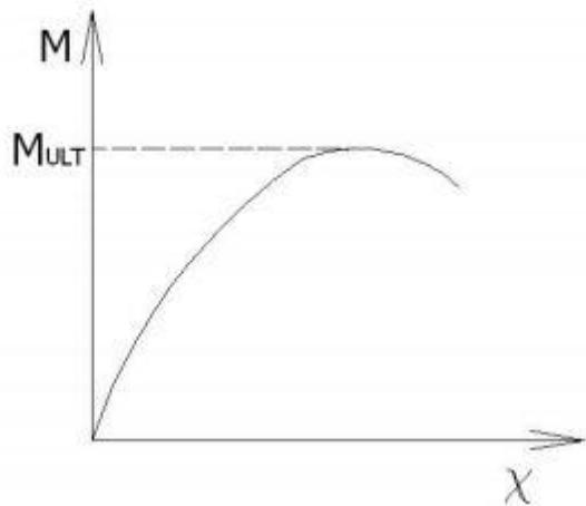
Slika 2 Ovisnost momenta savijanja o zakrivljenosti trupa [2]
