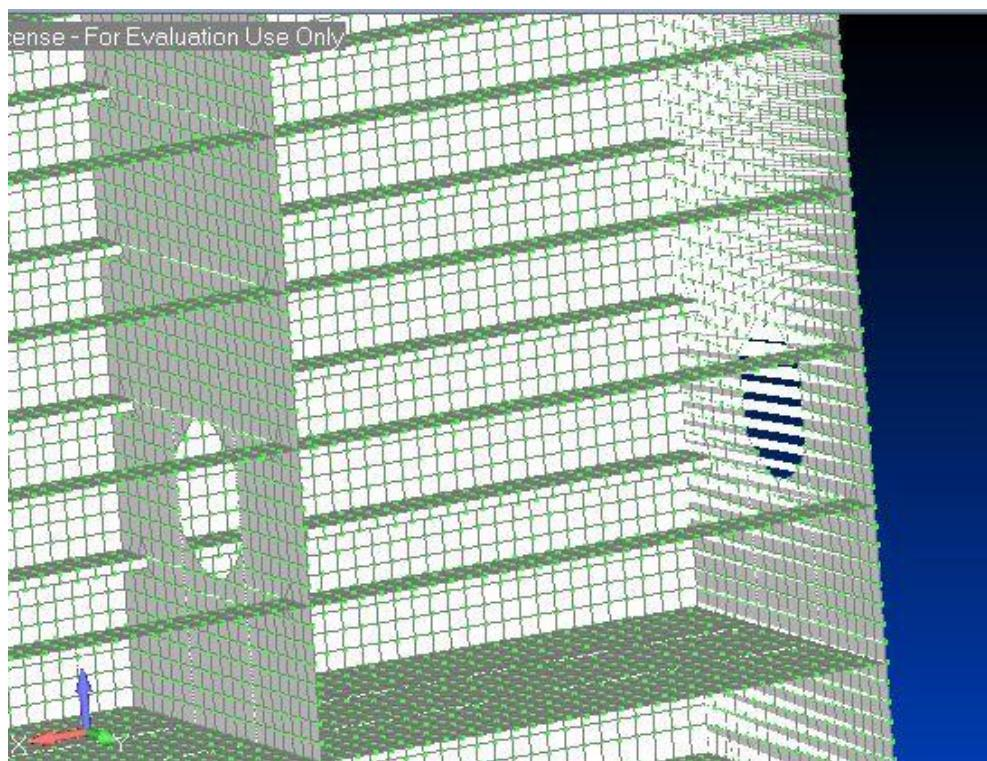
Slika 12 Detaljni prikaz strukture elemenata
