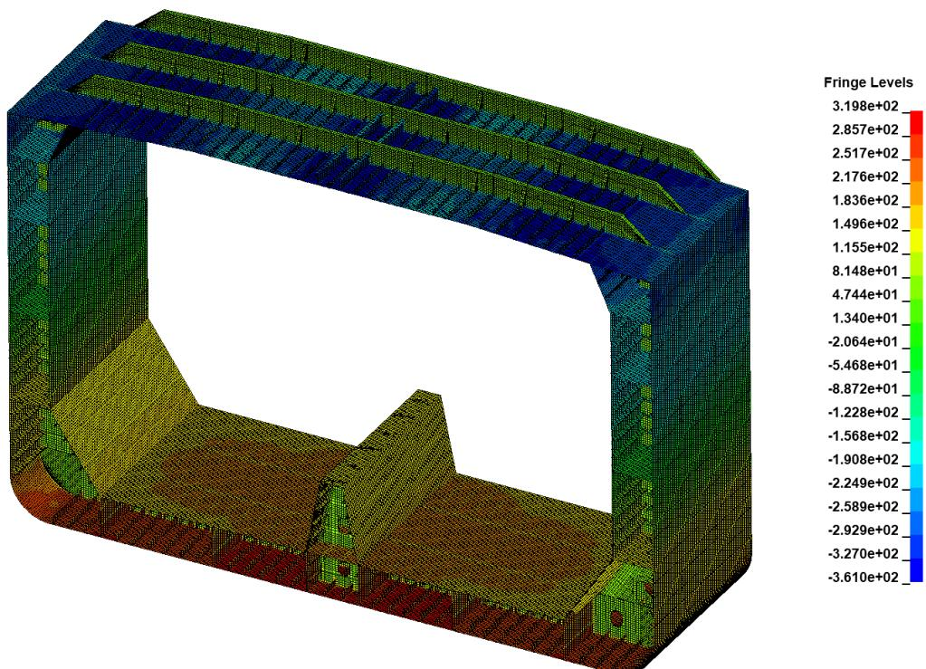
Slika 67 Naprezanja u smjeru osi x za  $M_{ULT}$
