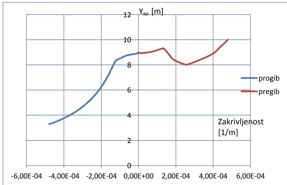
Slika 48 Ovisnost udaljenost neutralne linije i zakrivljenost
