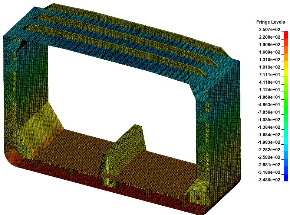
Slika 66 Naprezanja u smjeru osi x za  $0,8M_{ULT}$
