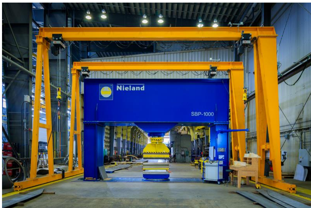
Slika 2.8 Suvremena preša za dvoosno oblikovanje limova, [1]
