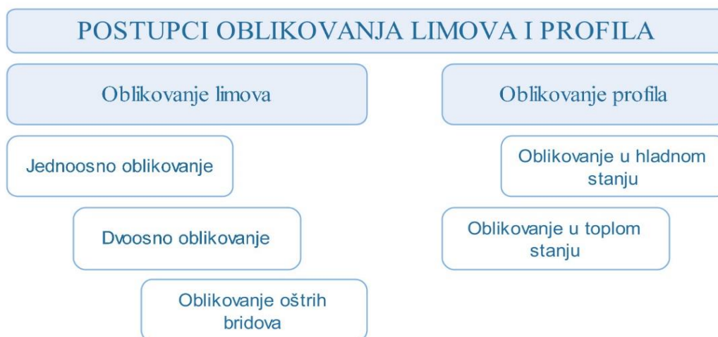
Slika 2.1 Klasifikacija postupaka oblikovanja limova i profila, [1]
