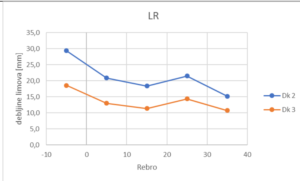
Slika 35. Promjena debljina limova po visinama prema LR-u
