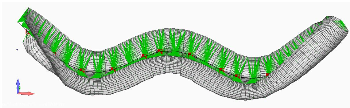
**Slika 16. MKE model broda 6 ( treći oblik vibriranja)**
