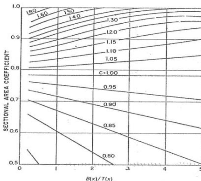
Slika 1. Lewisov dijagram za određivanje koeficijenta dvodimenzionalnog strujanja
