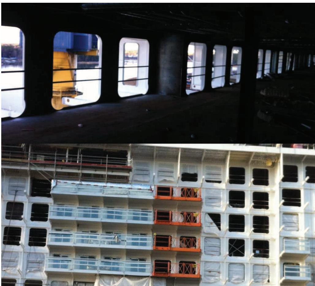
Slika 50. Izvedbe otvora u proizvodnji
