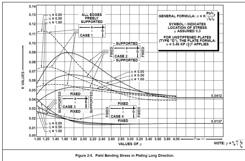
**Slika B.2** Naprezanje savijanja u polju opločenja u smjeru dulje stranice
