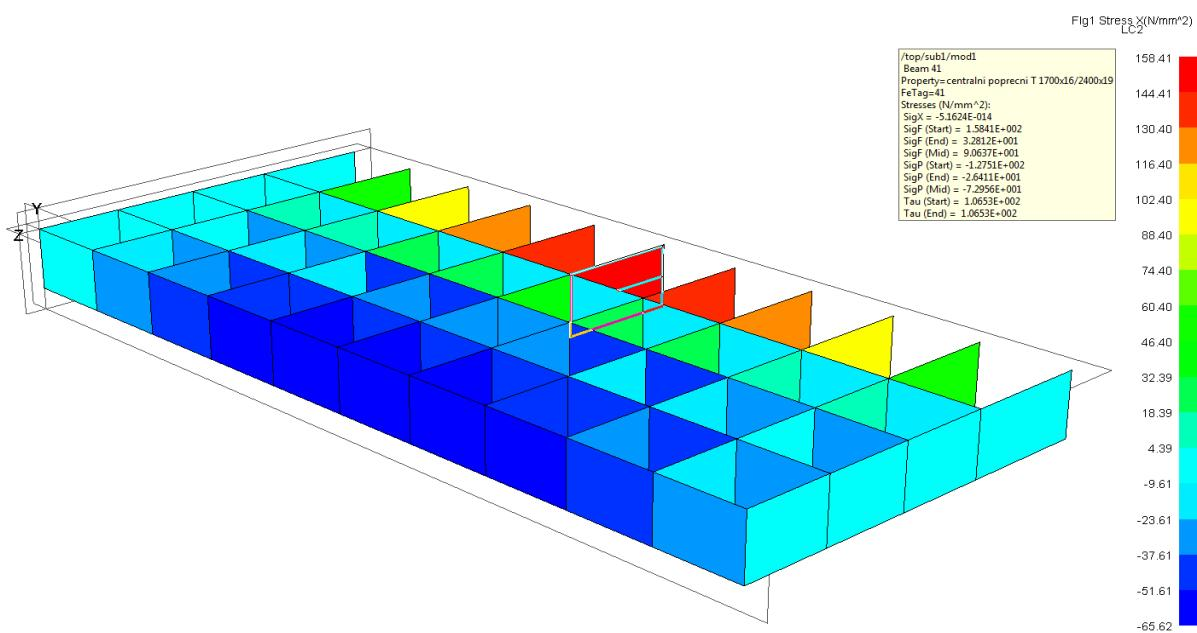
Slika 4.18 Prikaz naprezanja u prirubnicama grednog elementa
