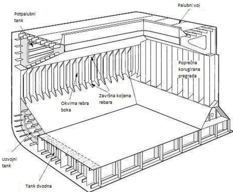
**Slika 1.1 Prikaz konstruktivnih karakteristika skladišnog prostora [2]**
