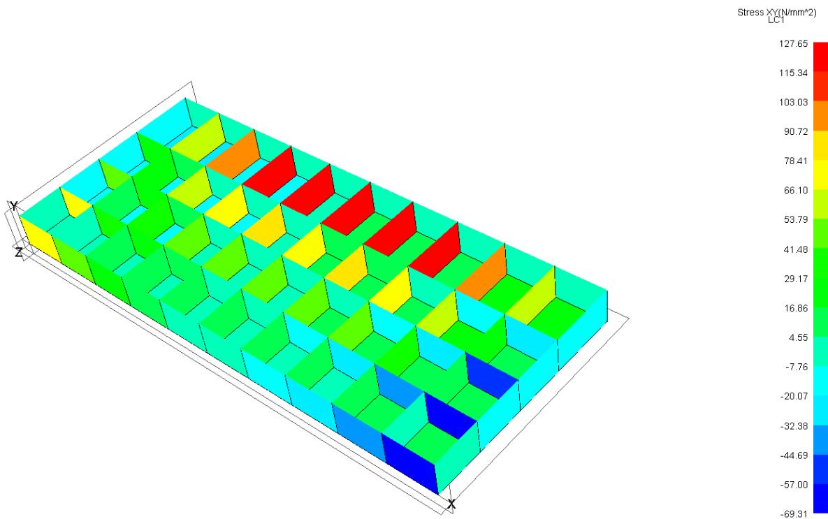
**Slika 4.8 Prikaz smičnih naprezanja modela sa grubom mrežom konačnih elemenata**
