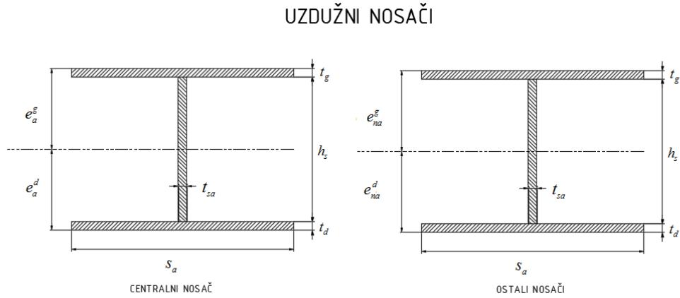
**Slika 3.10 Geometrijske karakteristike uzdužnih nosača**
