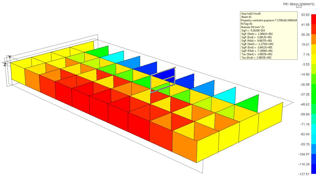
Slika 4.17 Prikaz naprezanja u strukovima grednog elementa
