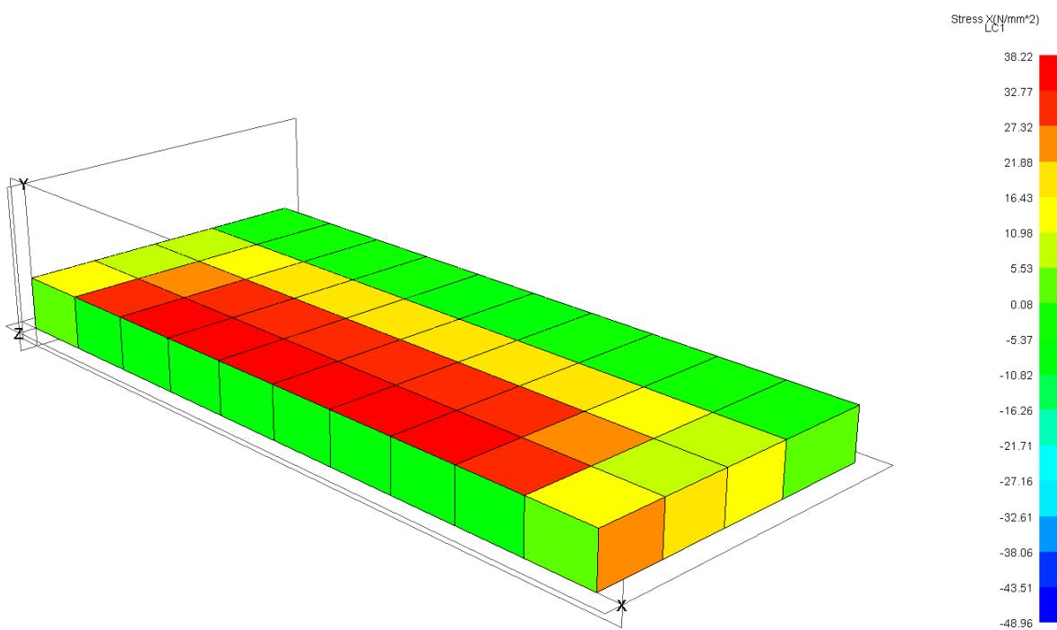
**Slika 4.6 Prikaz normalnih naprezanja u uzdužnom smjeru modela sa grubom mrežom konačnih elemenata**
