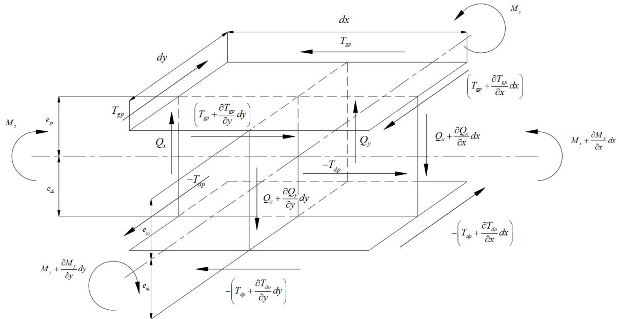
Slika 2.1 Diferencijalni element ortotropne ploče [4]
