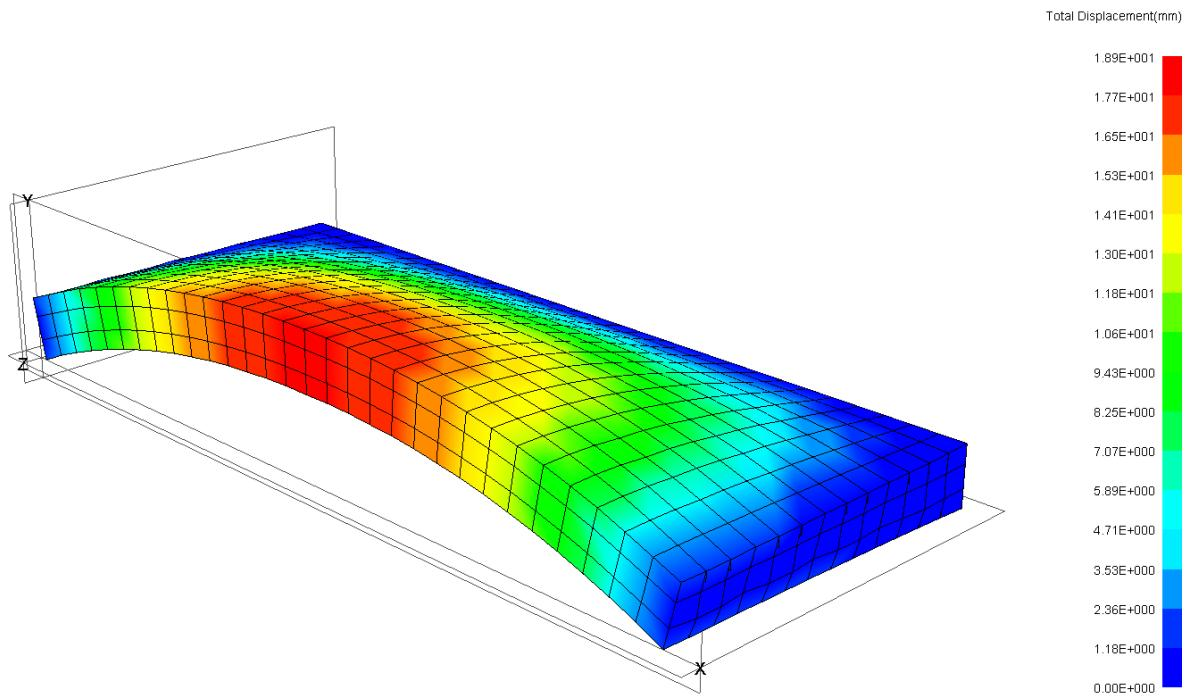
**Slika 4.11 Prikaz deformacija modela sa finom mrežom konačnih elemenata**
