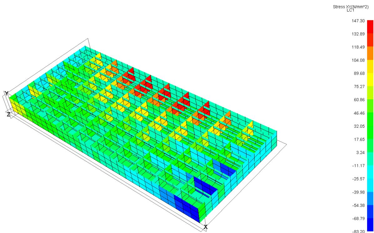
**Slika 4.14 Prikaz sručnih naprezanja modela sa finom mrežom konačnih elemenata**
