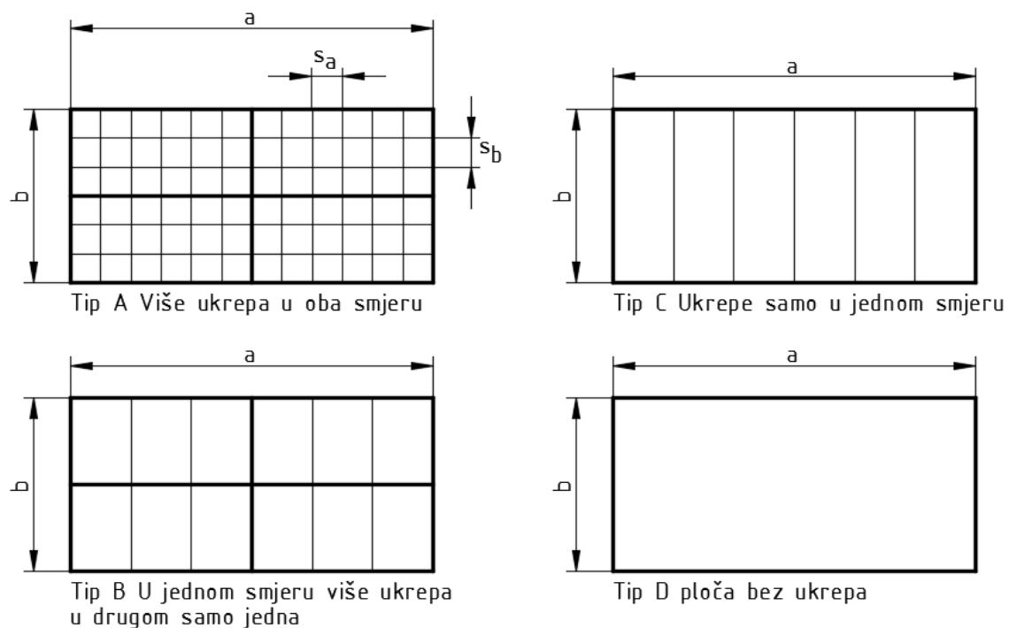
Slika 3.1 Tipovi ploča za Shadeovu metodu [4]
