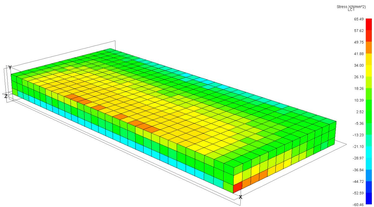
**Slika 4.12 Prikaz normalnih naprezanja u uzdužnom smjeru modela sa finom mrežom konačnih elemenata**
