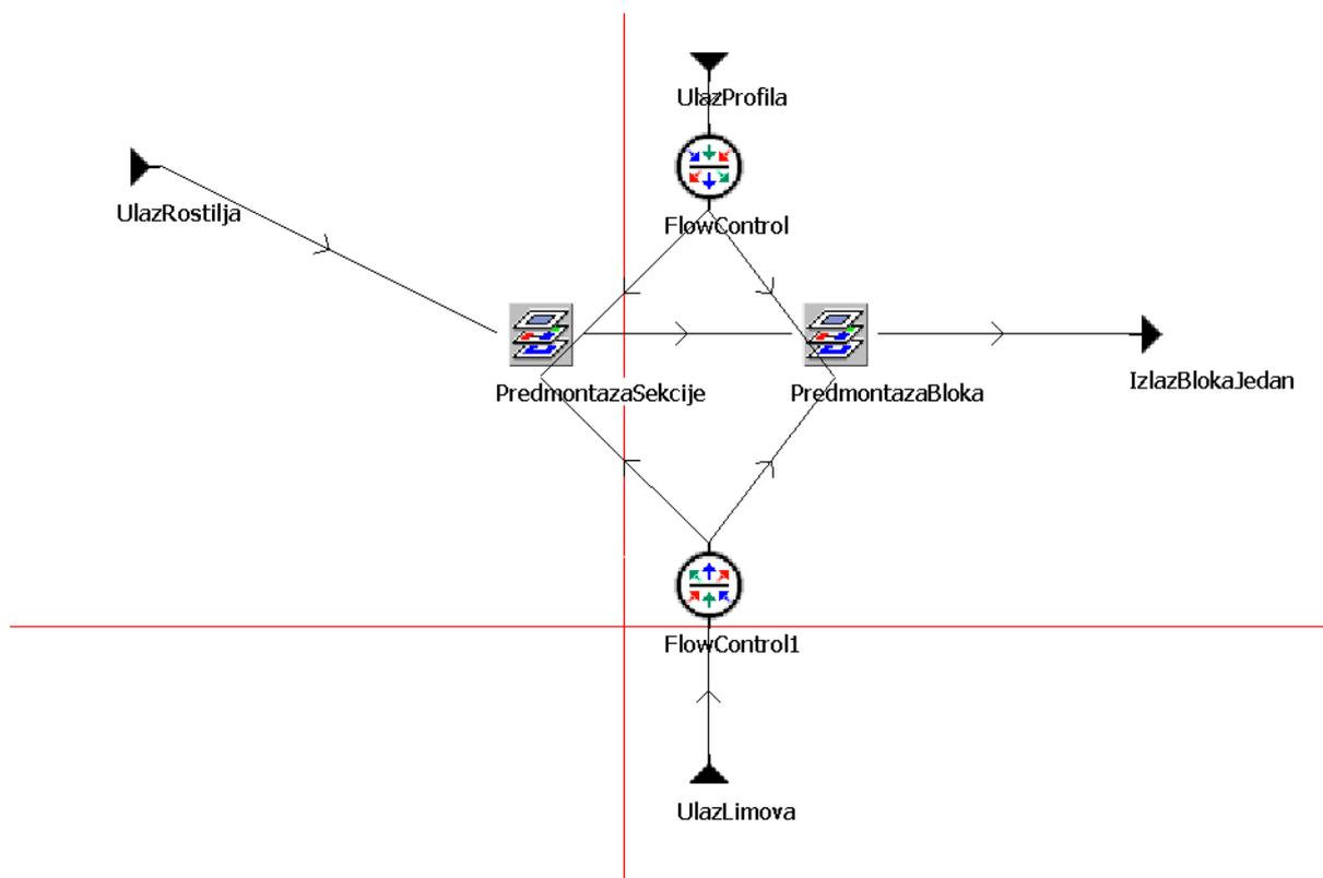
Slika 10. Model predmontaže i opremanja bloka složenije konstrukcije
