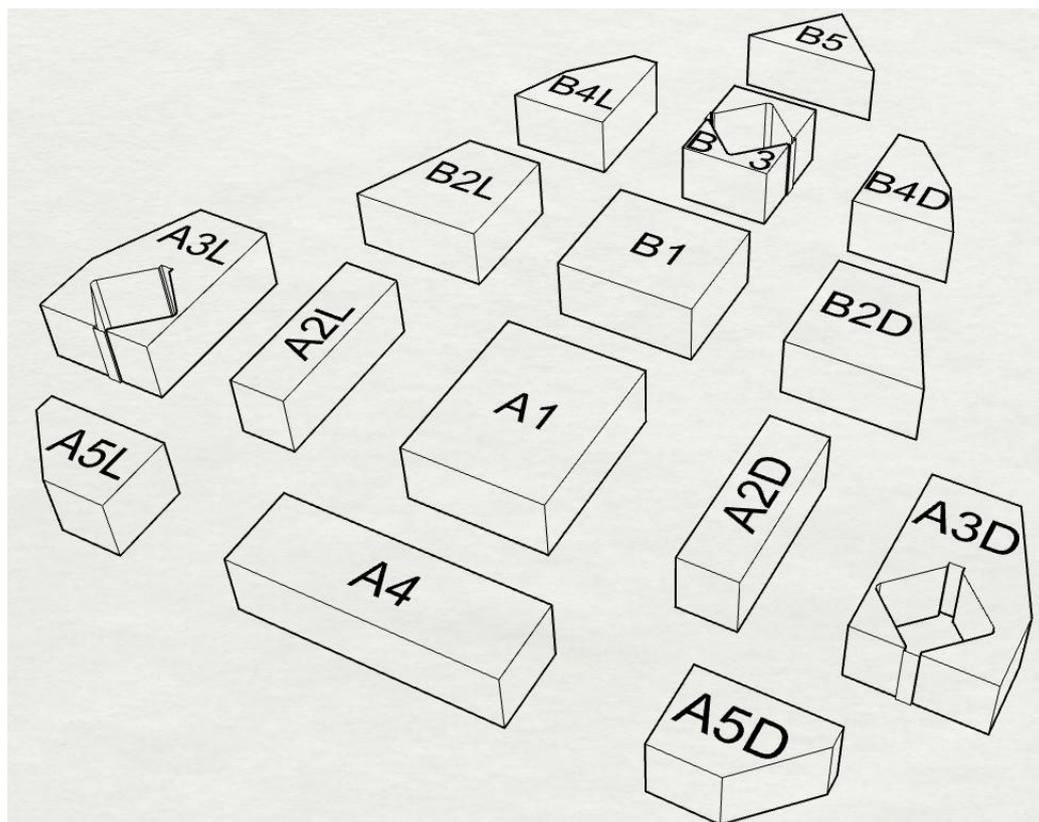
Slika 23. Tehnološka podjela trupa platforme na blokove
