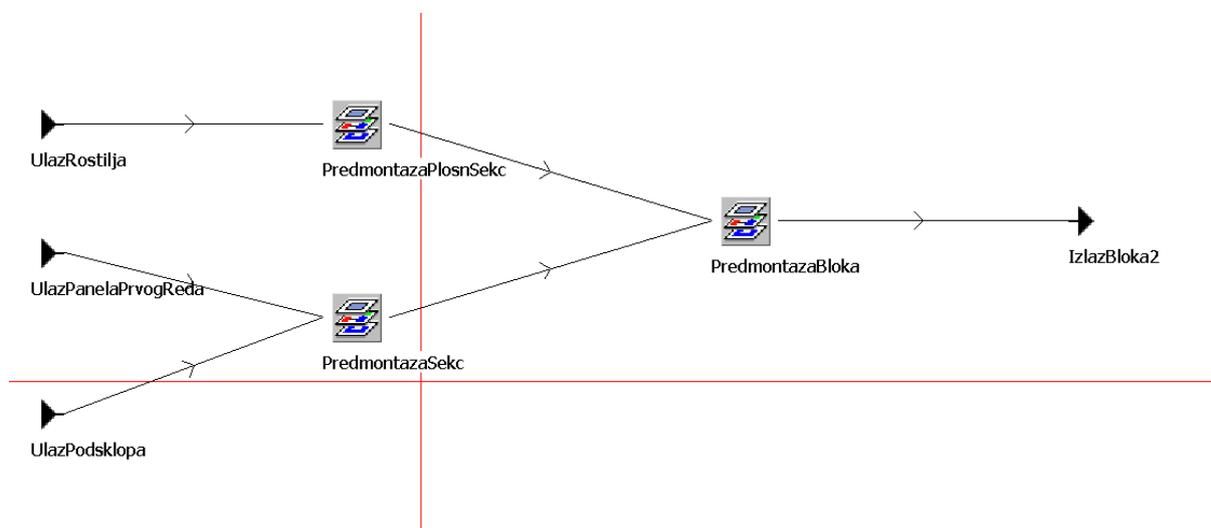
Slika 11. Model predmontaže i opremanja bloka jednostavnije konstrukcije
