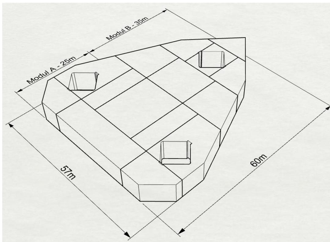
Slika 24. Tehnološka podjela trupa platforme na module
