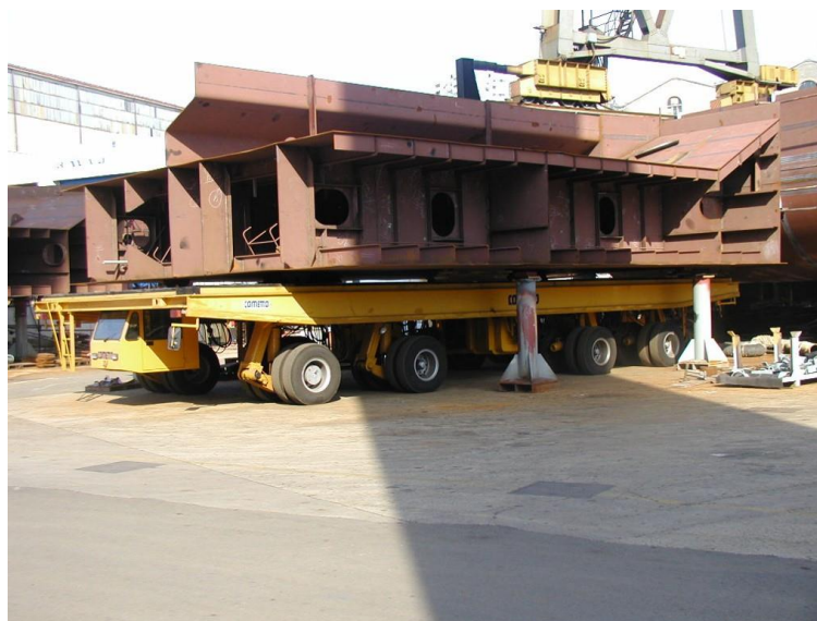
Slika 39. Primjer potklada na kojima se smješta sekcija brodskog trupa
