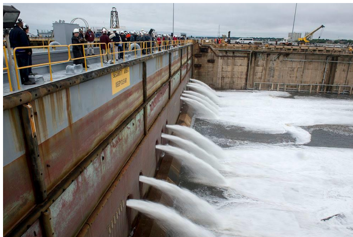
Slika 41. Potapanje plovnog doka [28]
