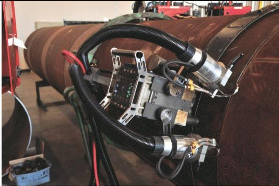
**Slika 32.** Glava za automatsko zavarivanje čeličnih cijevi [8]
