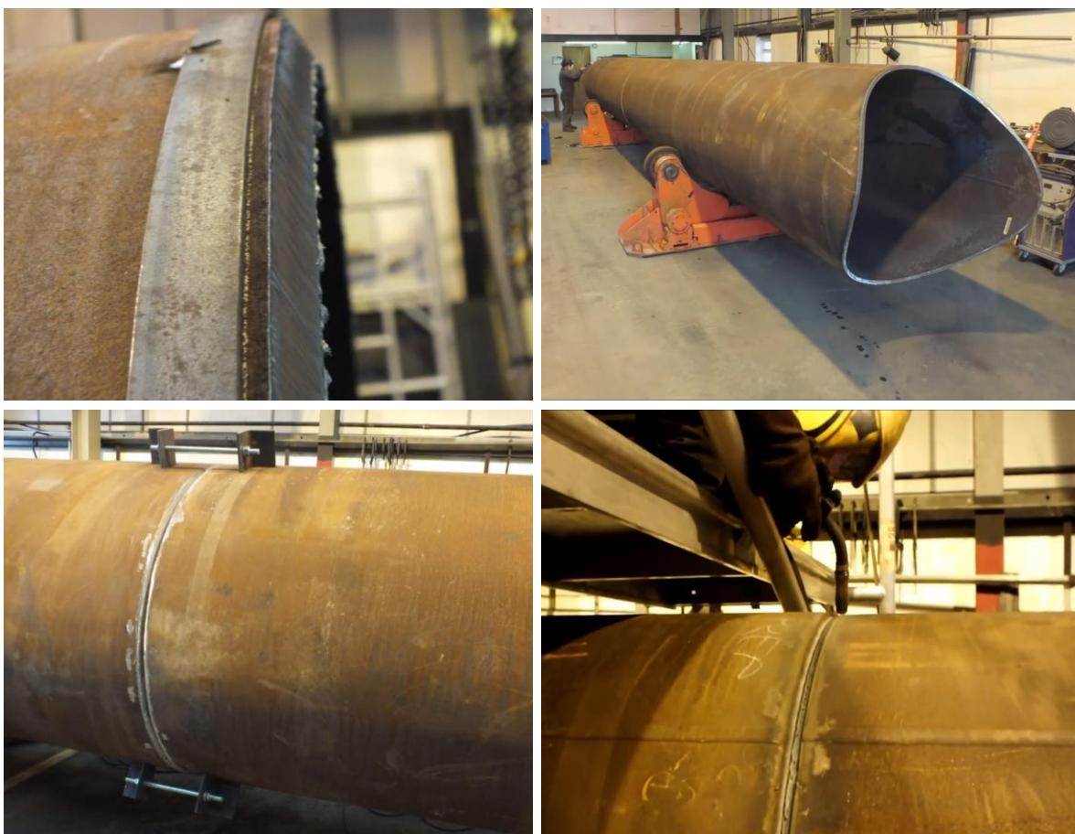
Slika 34. Prikaz „V“ pripreme spoja i fiksiranja cijevi [27]
