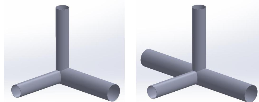
**Slika 37.** Predmontirani LL-spoj (lijevo) i TT-spoj (desno)
