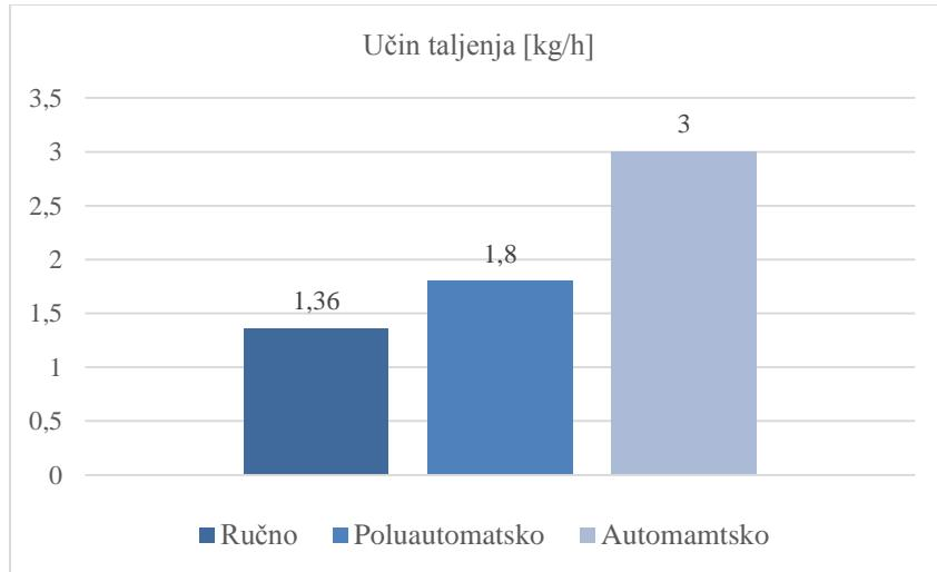
**Slika 33.** Usporedba učina taljenja raznih tehnika zavarivanja cijevi [21]
