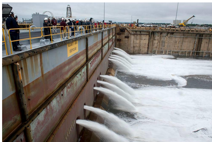
Slika 41. Potapanje plovnog doka [28]
