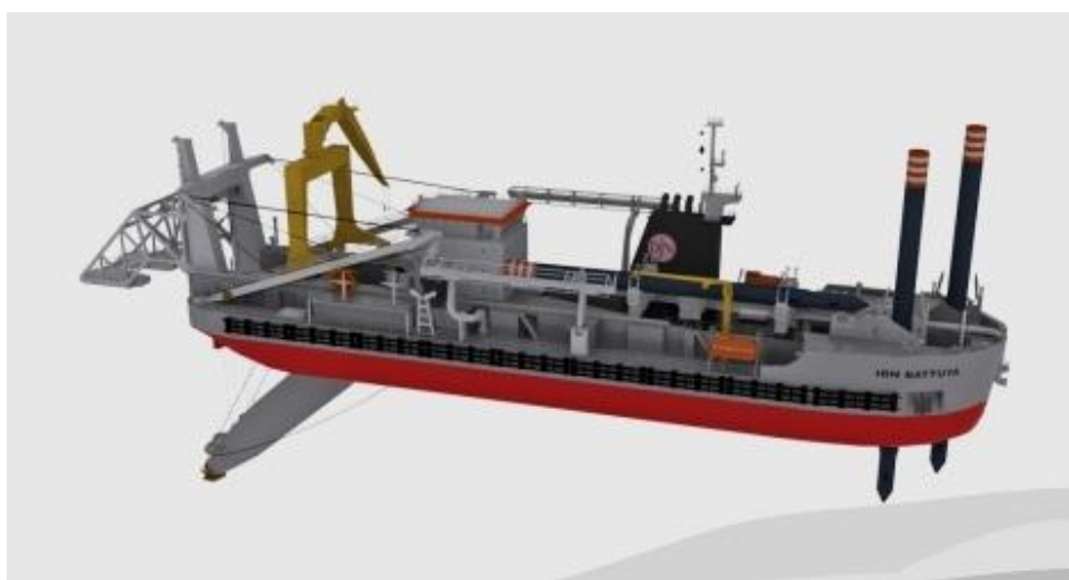
Slika 10 Model jaružala opremljenog sjekačem [2]
