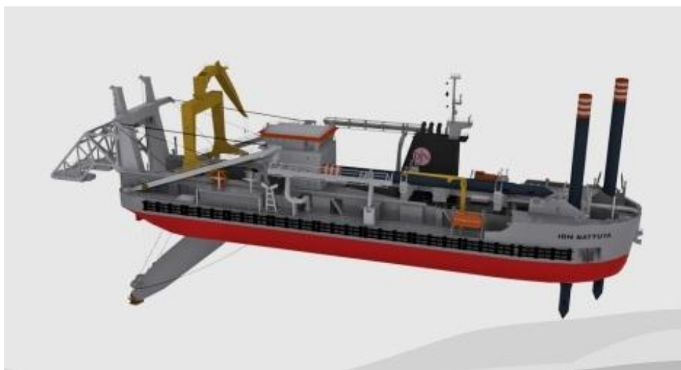
Slika 10 Model jaružala opremljenog sjekačem [2]
