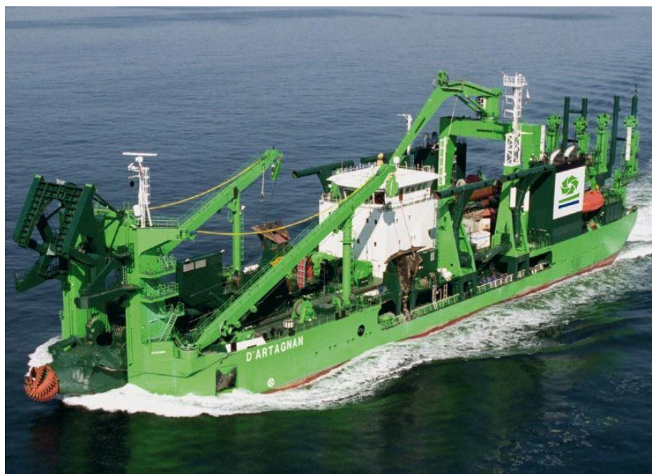
Slika 4 Usisno jaružalo opremljeno sjekačem
