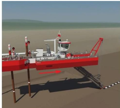
**Položaj 2** - sjekač se nalazi u krajnjem desnom položaju, prvi je kružni luk opisan. Jaružar se kreće pomicati prema naprijed "odgurujući" se od kolica pilona.
