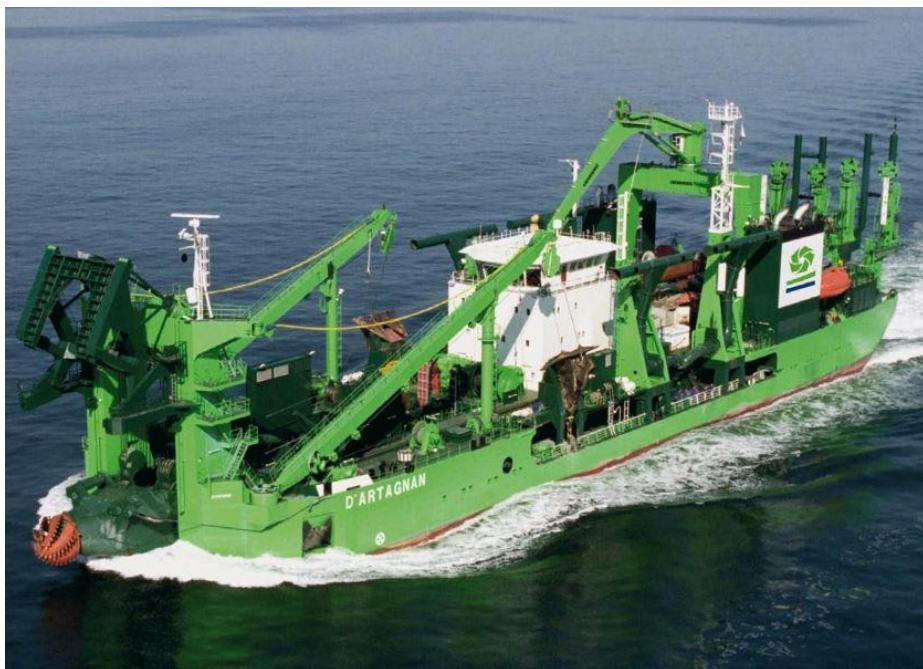
Slika 4 U sisno jaružalo opremljeno sjekačem
