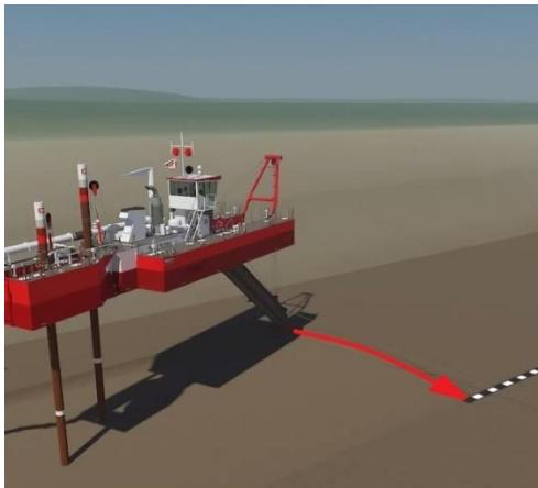
**Položaj 1** - glavni pilon zabijen je u dno, dok je pomoći pilon podignut. Glava sjekača nalazi se u krajnjem lijevom položaju. Počinje se zatezati desni čelični kabel i brod se oko zabijenog pilona počinje rotirati u desno dok glava sjekača usitnjava, a pumpa usisava materijal sa dna.
