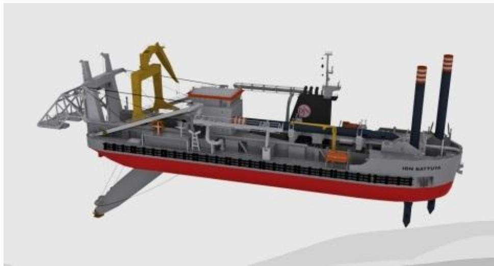
Slika 10 Model jaružala opremljenog sjekačem [2]
