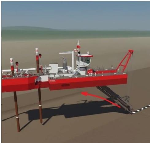
**Položaj 3** - glavni je pilon za uzdužni pomak broda udaljeniji od glave sjekača (veći radijus) i zatezanjem lijevog čeličnog kabela, počinje se opisivati novi koncentrični kružni luk. Proces se ponavlja dok kolica pilona ne dođu u krajnji položaj.
