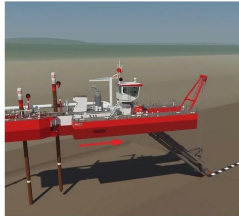
Položaj 2 - sjekač se nalazi u krajnjem desnom položaju, prvi je kružni luk opisan. Jaružar se kreće pomicati prema naprijed "odgurujući" se od kolicila pilona.
