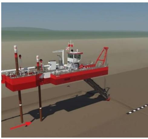
**Položaj 5** - nakon što je glavni pilon podignut, a pomoći spušten, kolica se počinju gibati prema naprijed dok ne dođu u krajnji položaj (najblže sjekaču), a zatim se glavni pilon ponovo spušta, a pomoći podiže.
