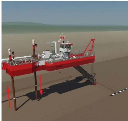
Položaj 4 - nakon što su kolicila pilona došla u krajnji položaj, brod se više ne može odgurivati prema naprijed. Potrebno je spustiti pomoćni pylon kako bi brod ostao na mjestu, dok se pylon u kolicima podiže.
