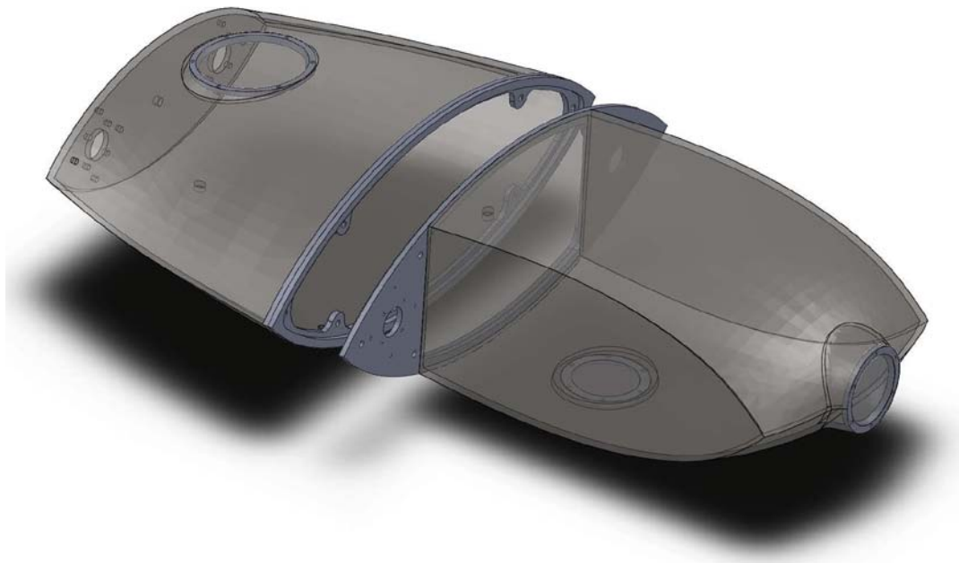
Slika 4 – Otvoreni SolidWorks sklop ronilice
