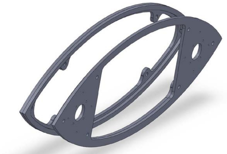
Slika 6 – Glavno rebro (rastavljeno) u SolidWorksu
