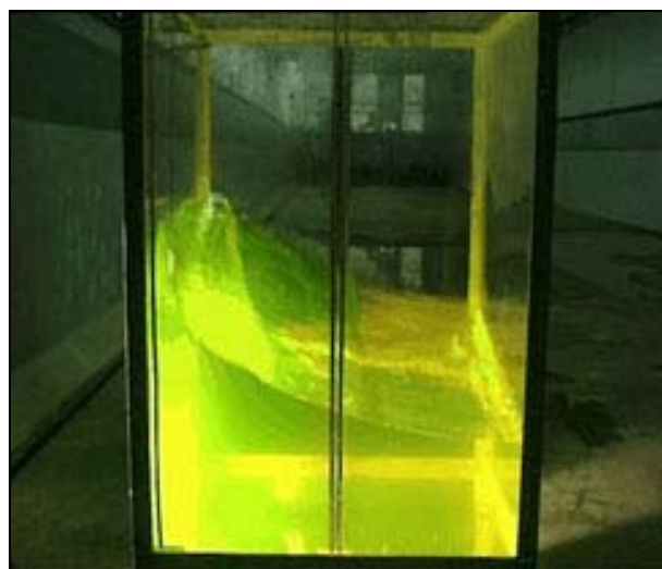
Slika 3.2. Zapljuskivanje u pravokutnom tanku [11]
