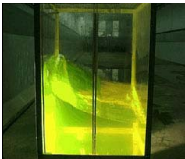
Slika 3.2. Zapljuskivanje u pravokutnom tanku [11]
