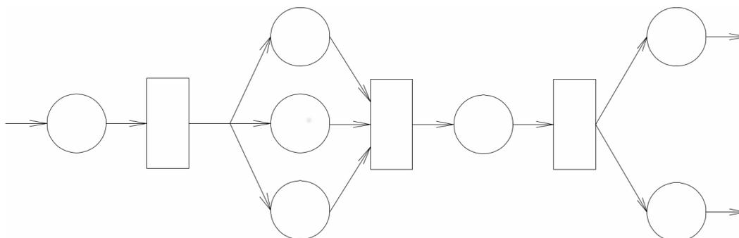
Slika 8. Linijski proizvodni proces s paralelnim strojevima
