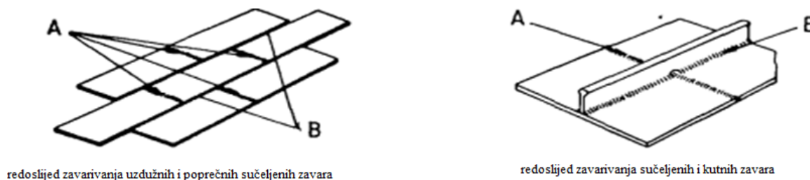
Slika 15. Prikaz redoslijeda zavarivanja
