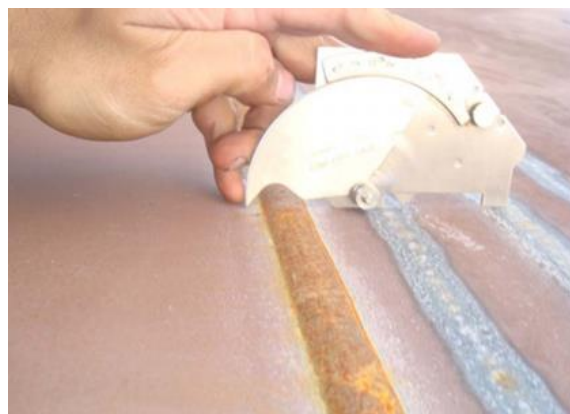
Slika 26. Provjera smaka zavara
