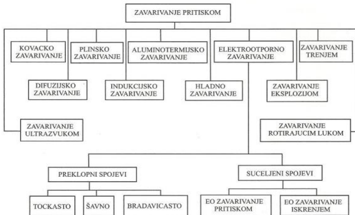
Slika 1. Podjela postupaka zavarivanja pritiskom
