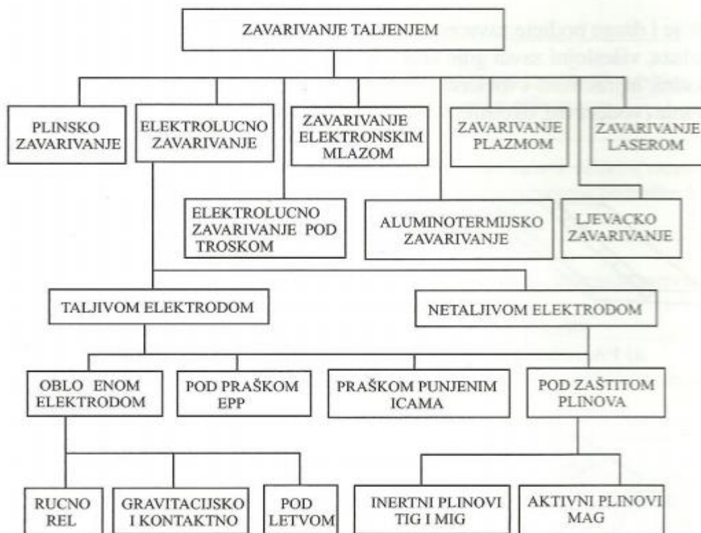
Slika 2. Podjela postupaka zavarivanja taljenjem
