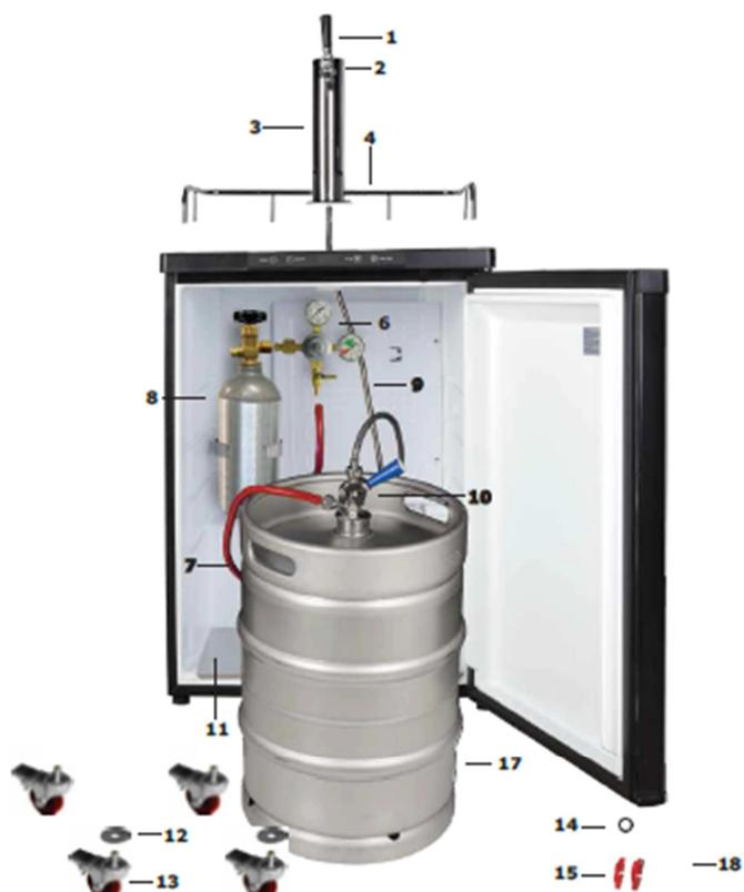
**Slika 10. Standardni dijelovi uređaja za točenje piva**
