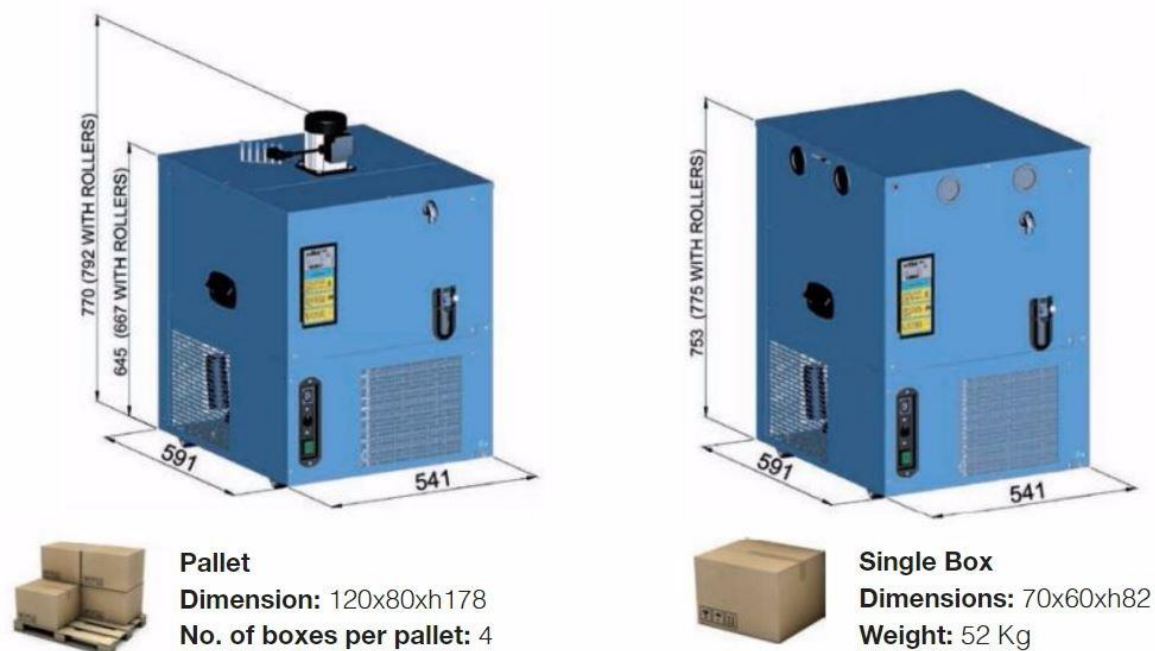
Slika 19. Celli Tornado Evolution 65 dimenzije
