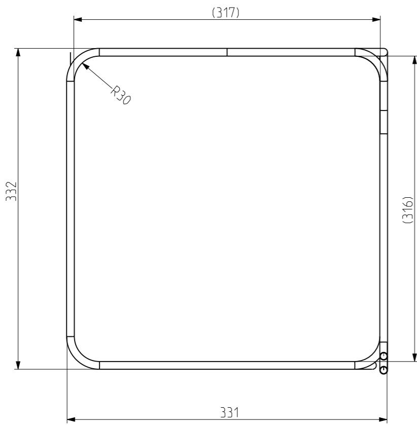
Napomena: Dimenzije cijevi:  $\phi 8/\phi 7 \times 21000$ .
