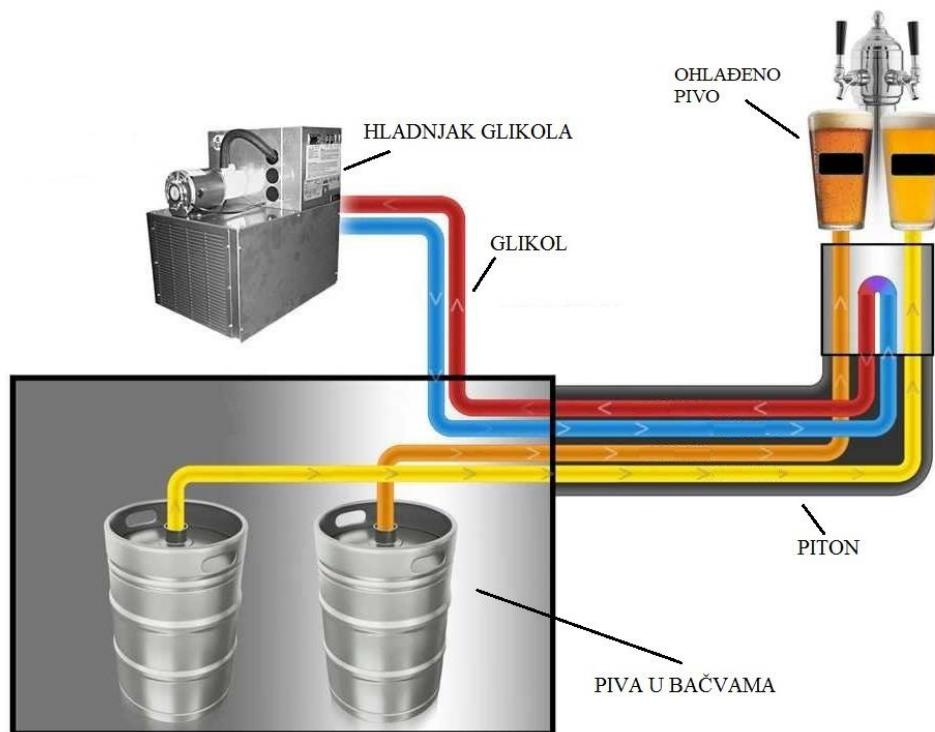
Slika 9. Princip rada aparata za protočno hlađenje, [8]
