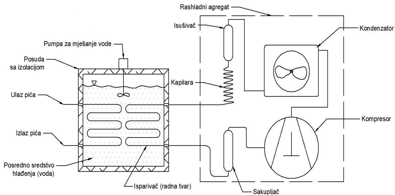
**Slika 12. Shema protočnog hlađenje pića**
