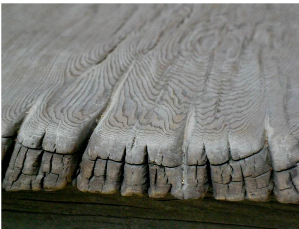
Slika 29. Trošenje drva habanjem [30]
