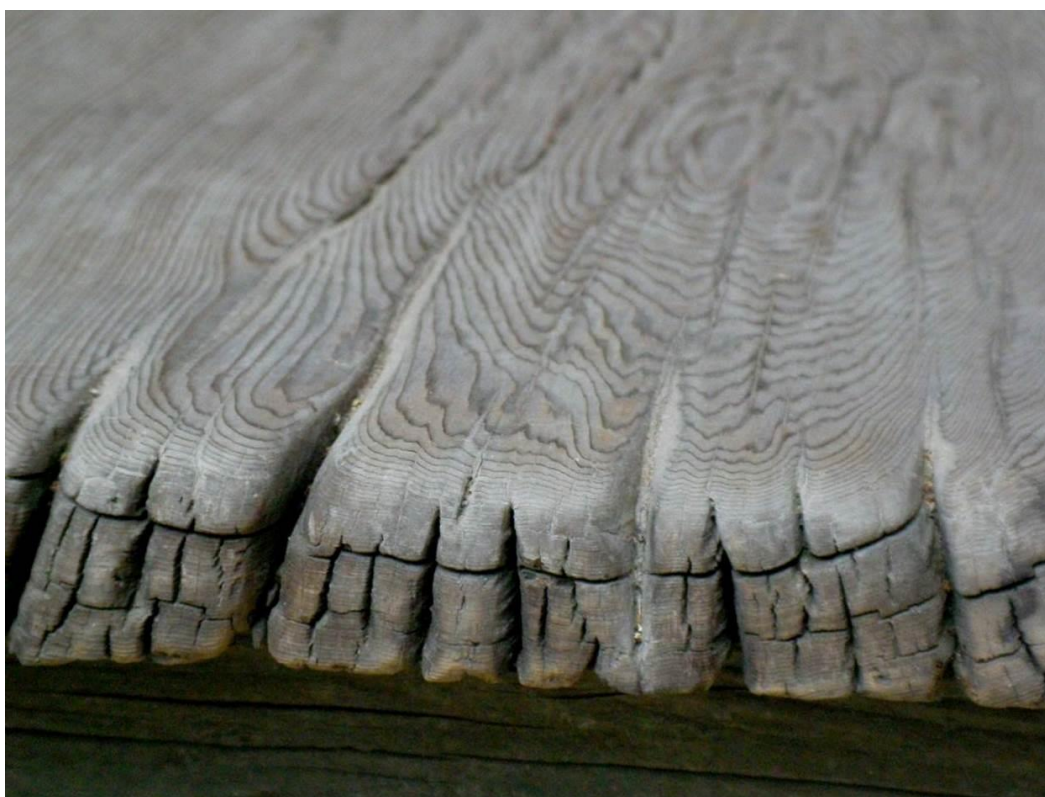
Slika 29. Trošenje drva habanjem [30]
