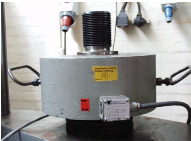
Slika 21 Dinamometar Z4/500 kN
