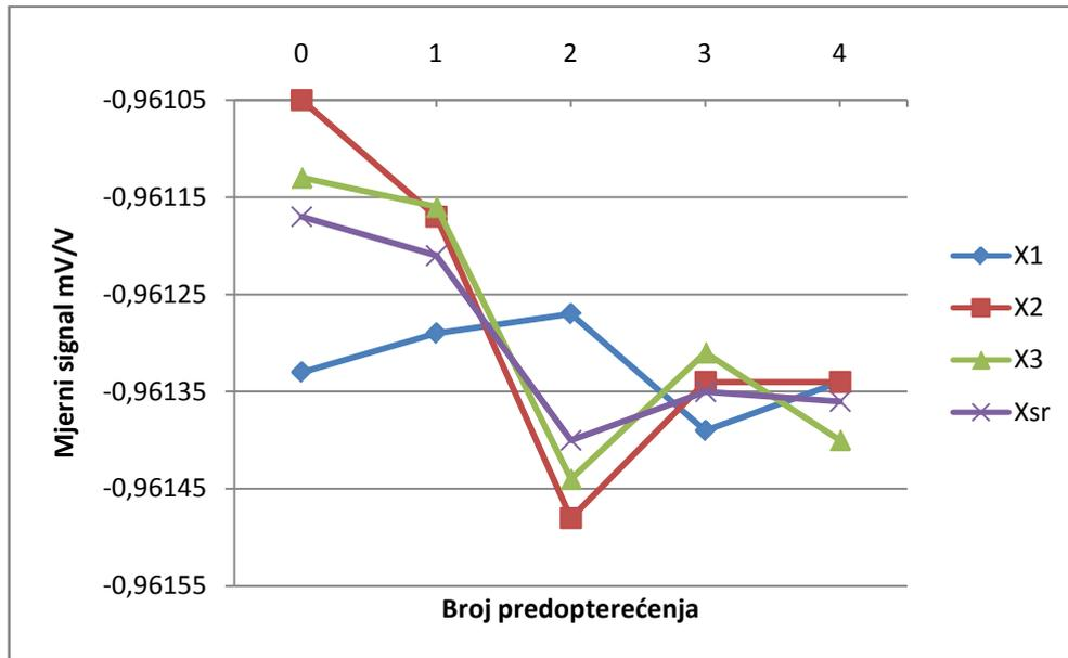
Slika 30 Vrijednost mjernog signala pri induciranoj sili 240 kN
