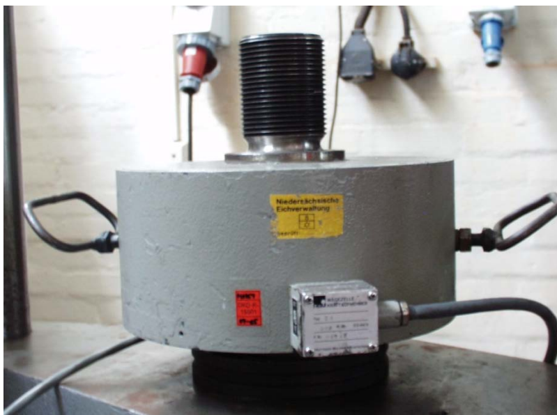
Slika 21 Dinamometar Z4/500 kN
