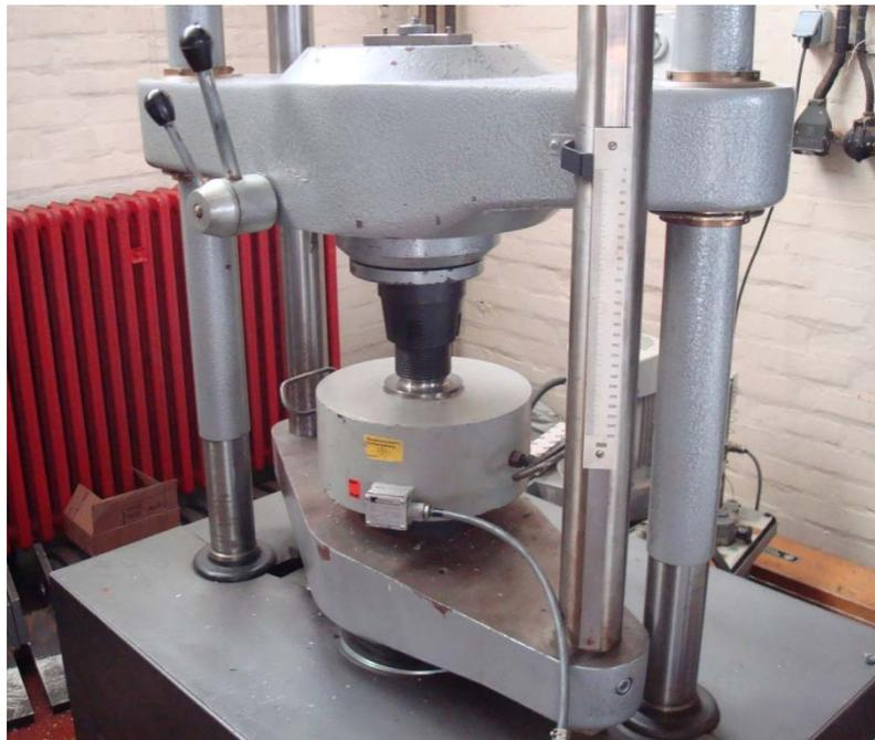
**Slika 24 Tlačno predopterećenje kidalice i dinamometra**
