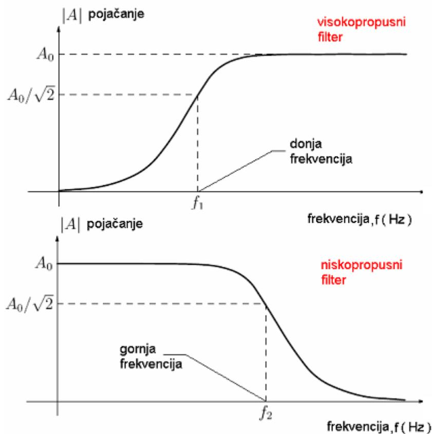
**Slika 19 Usporedba karakteristika visokopropusnog i niskopropusnog filtera**
