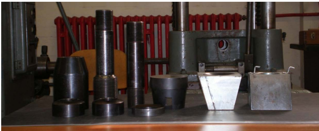
Slika 23 Prihvatne naprave za vlačno/tlačno opterećivanje
