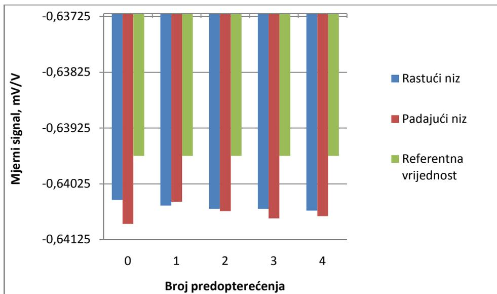
Slika 34 Mjerni signal za rastući i padajući niz te referentna vrijednost za mjernu točku 160 kN
