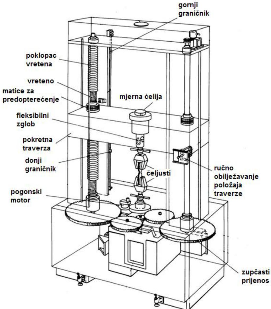
**Slika 3 Elektromehanička kidalica**
