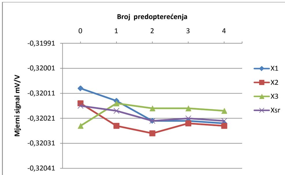
Slika 28 Vrijednost mjernog signala pri induciranoj sili 80 kN
