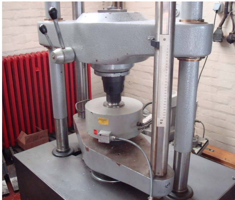
Slika 24 Tlačno predopterećenje kidalice i dinamometra
