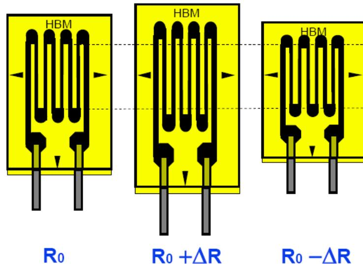
Slika 11 Utjecaj deformacije na promjenu otpora mjerne trake
