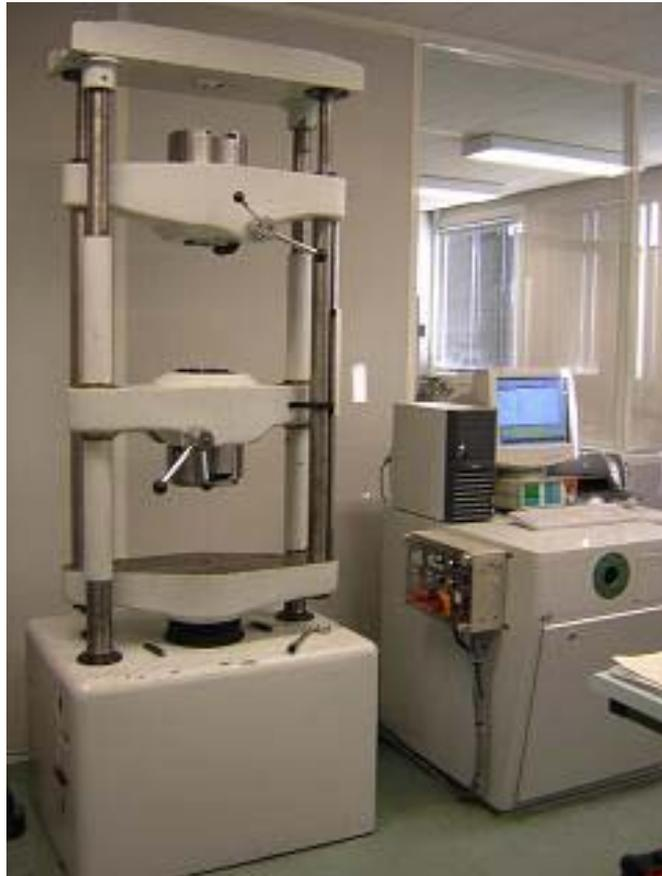
**Slika 4 Hidraulička kidalica**
