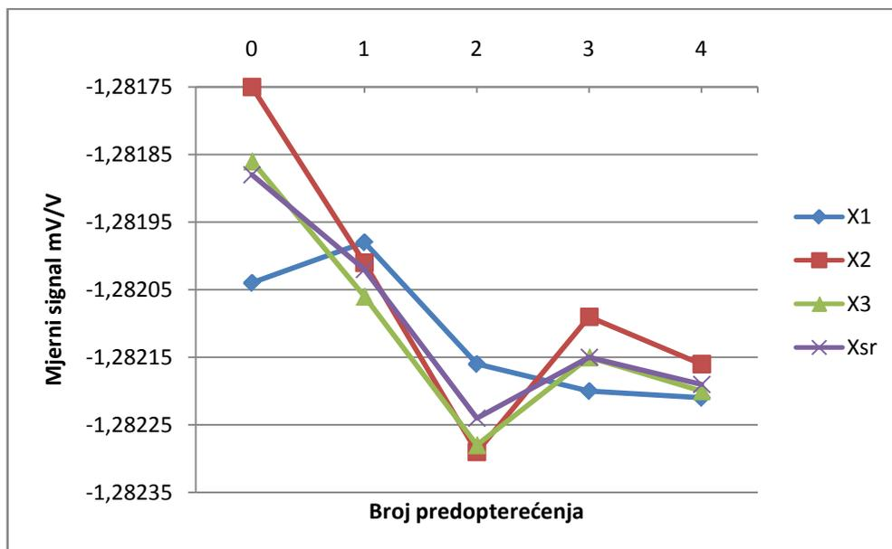
Slika 11 Vrijednost mjernog signala pri induciranoj sili 320 kN
