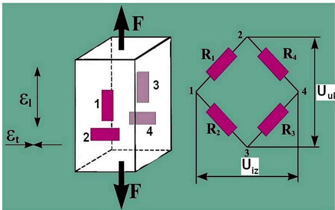
Slika 13 Wheatstonov most s četiri mjerne trake
