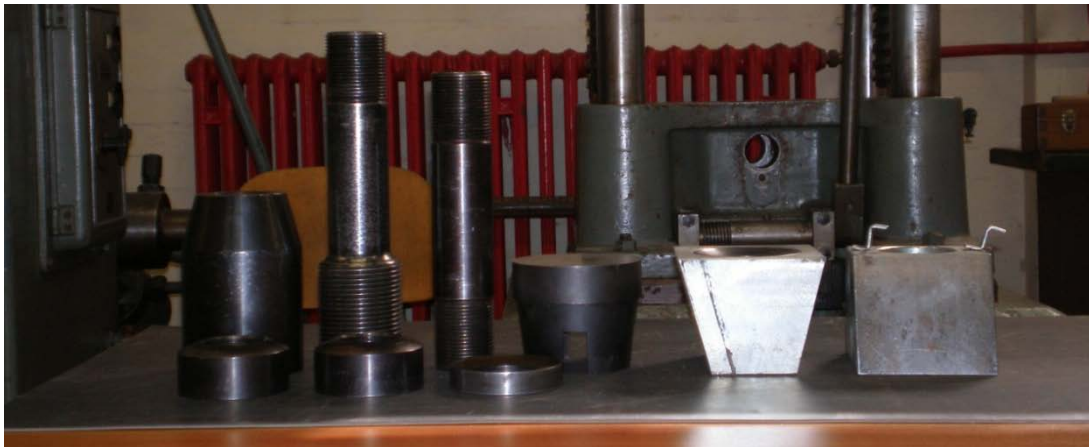
Slika 23 Prihvatne naprave za vlačno/tlačno opterećivanje
