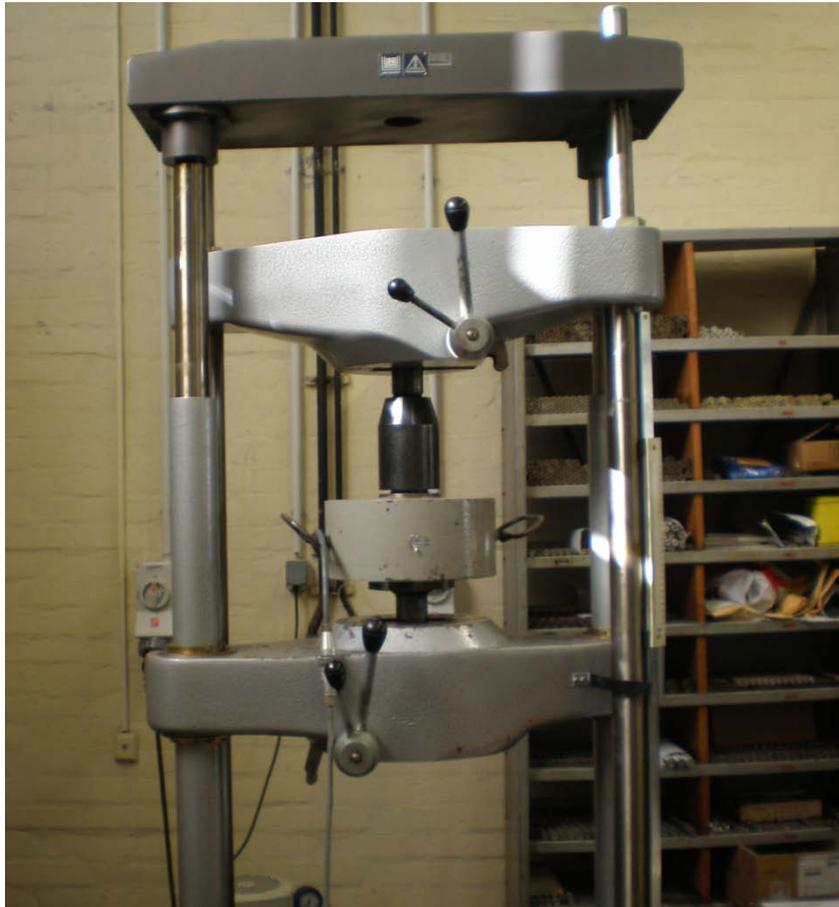
**Slika 26 Vlačno umjeravanje kidalice**
