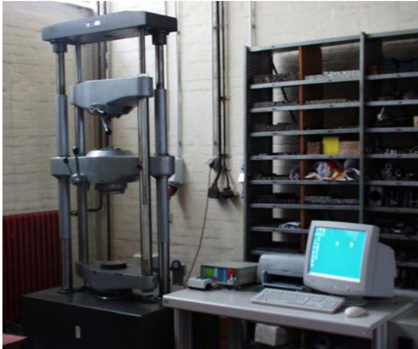
**Slika 20 Hidraulična kidalica WPM EU 40 mod.**
