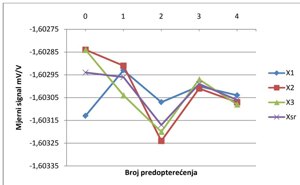
**Slika 32 Vrijednost mjernog signala pri induciranoj sili 400 kN**
