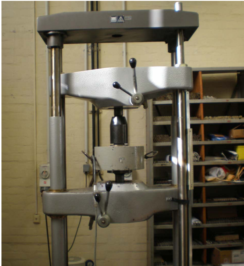
Slika 26 Vlačno umjeravanje kidalice
