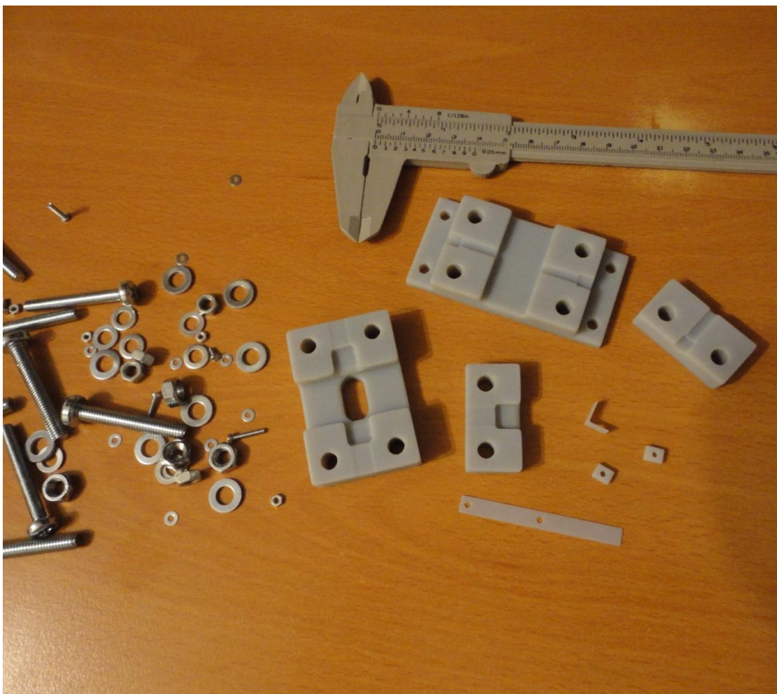
Slika 97 Izrađeni dijelovi senzora za mjerenje vibracija
