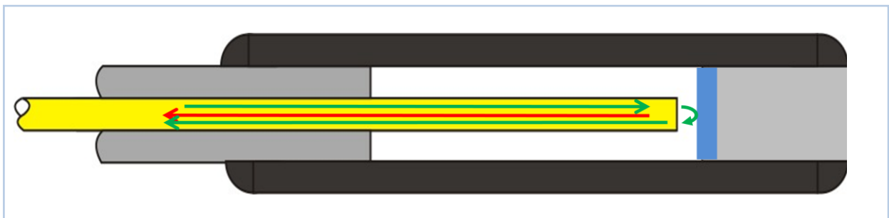
Slika 6 Senzor s vibrirajućom svjetlovodnom jezgrom (refleksivni tip)
