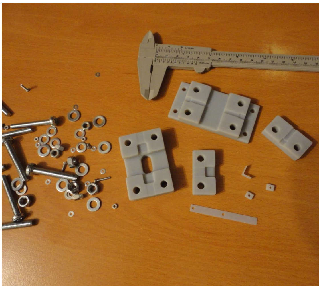
Slika 97 Izrađeni dijelovi senzora za mjerenje vibracija
