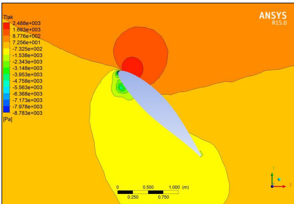
Slika 28. Raspodjela tlaka u presjeku profila NA64618
