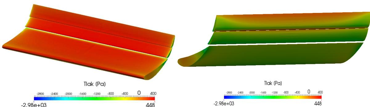
Slika 6.1: Raspodjela kinematičkog tlaka na stražnjem krilu – varijanta 2
