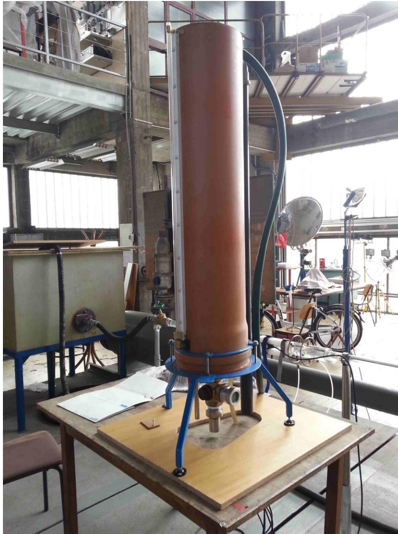
Slika 13. Mjerna posuda za umjeravanje protoka
