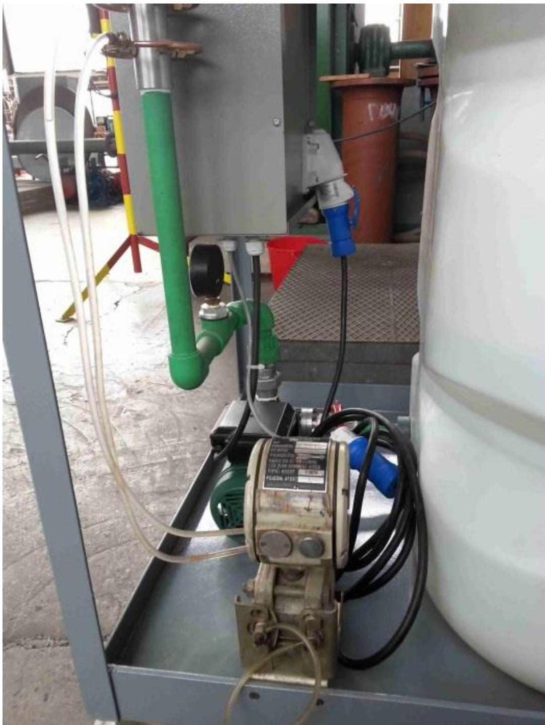
Slika 8. Stvarna izvedba mjernog lanca za mjerjenje protoka
