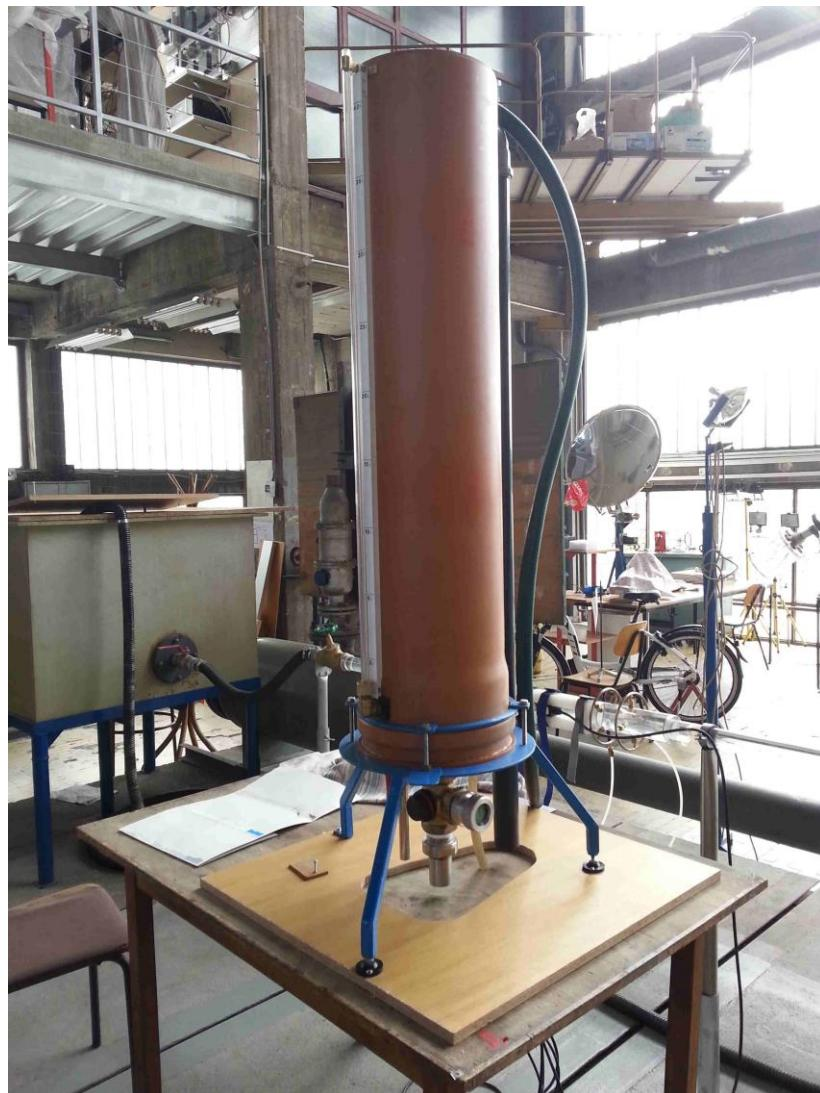
**Slika 13. Mjerna posuda za umjeravanje protoka**
