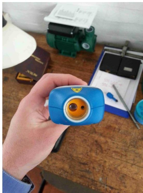
Slika 22. Prednji kraj digitalnog ručnog tahometra
