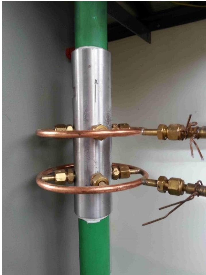
Slika 9. Venturijeva cijev
