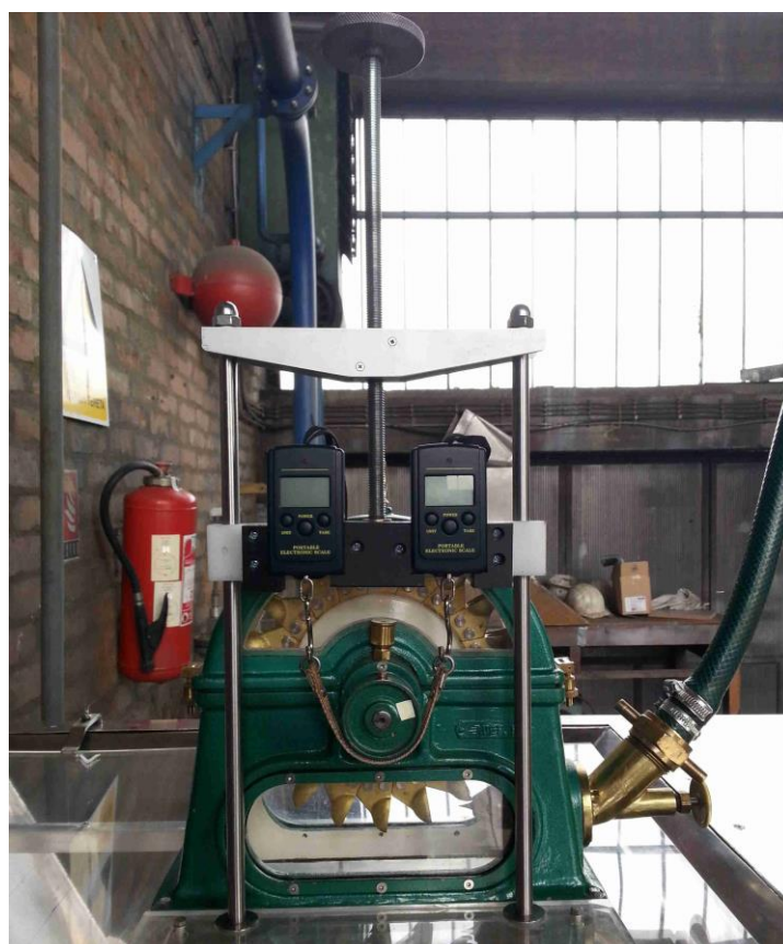
Slika 18. Stvarna izvedba mjernog lanca za mjerenje okretnog momenta
