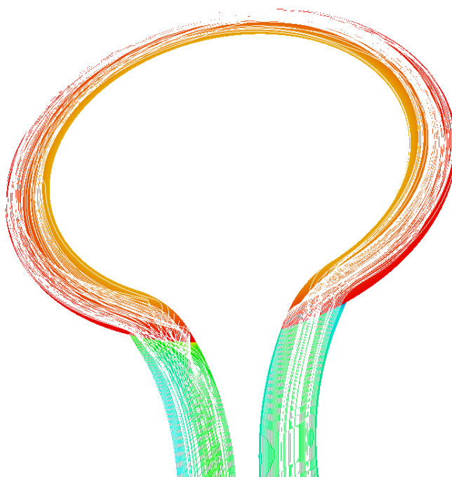
Slika 49. Prikaz strujnica na cjeloukupnom modelu ( h = 0.25 \text{ mm} ) u radnoj točki Q = 8.1 \text{ l/min} i n = 500 \text{ o/min}
