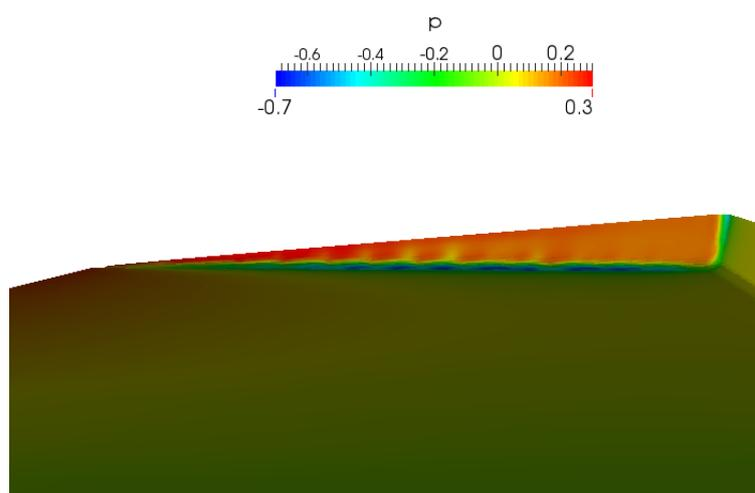
Slika 4.3: Uvećani prikaz tlaka na krmu uz bočni nagib od  $5^\circ$
