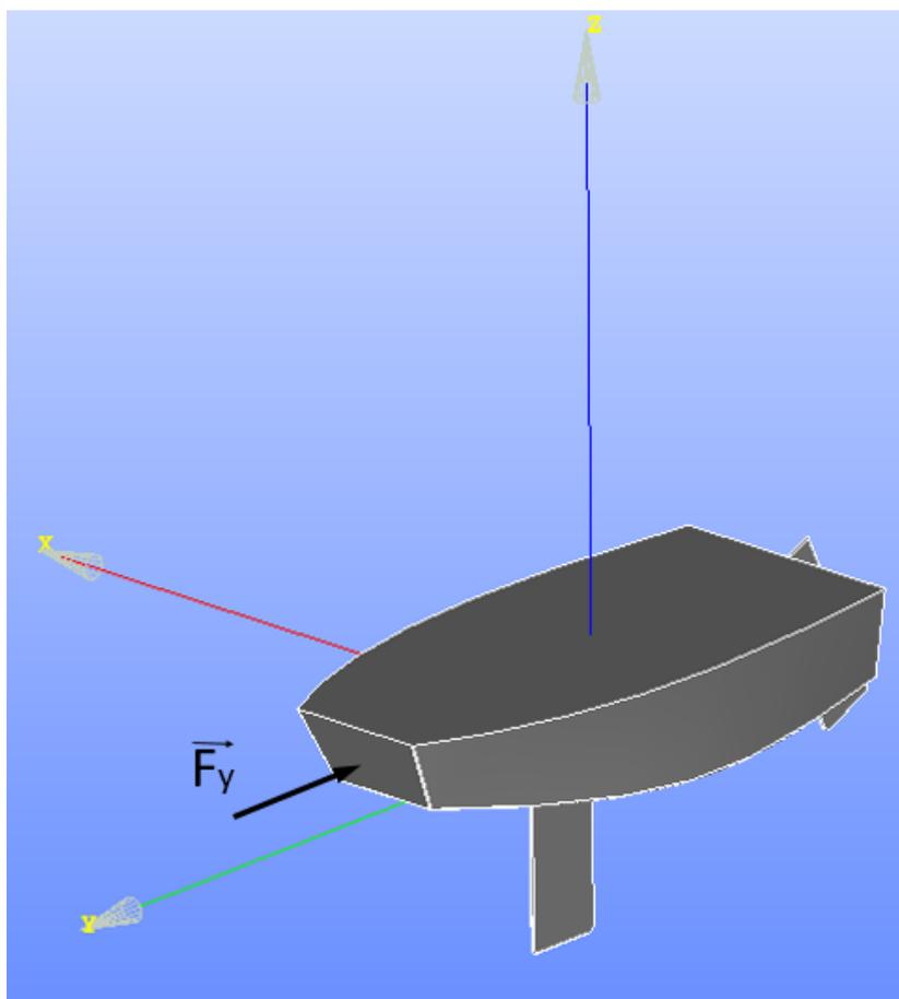
Slika 5.4: Prikaz smjera djelovanja hidrodinamičke sile otpora
