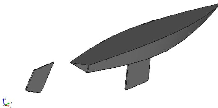
Slika 3.6: Istisnina jedrilice uz bočni nagib od  $20^\circ$
