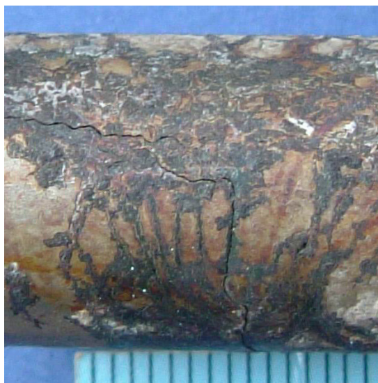
Slika 8. Primjer napetonske korozije [15]
