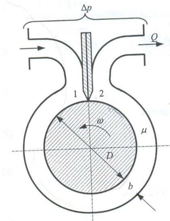
Slika 34. Shema cilindrične frikcijske pumpe [29]
