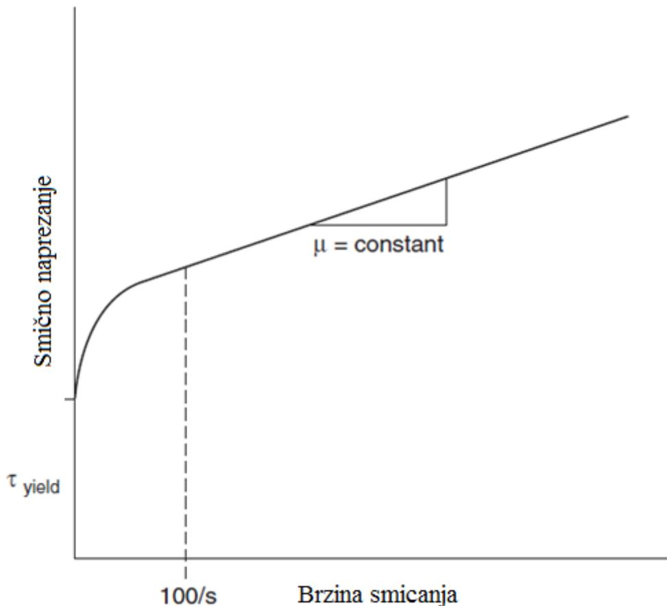
**Slika 2. Odnos gradijenta brzine i smičnog naprezanja [7]**
