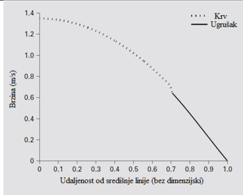
Slika 18. Predviđanje profila brzine krvni-ugruška 0.05s nakon primjene kriterija zamjene [14]
