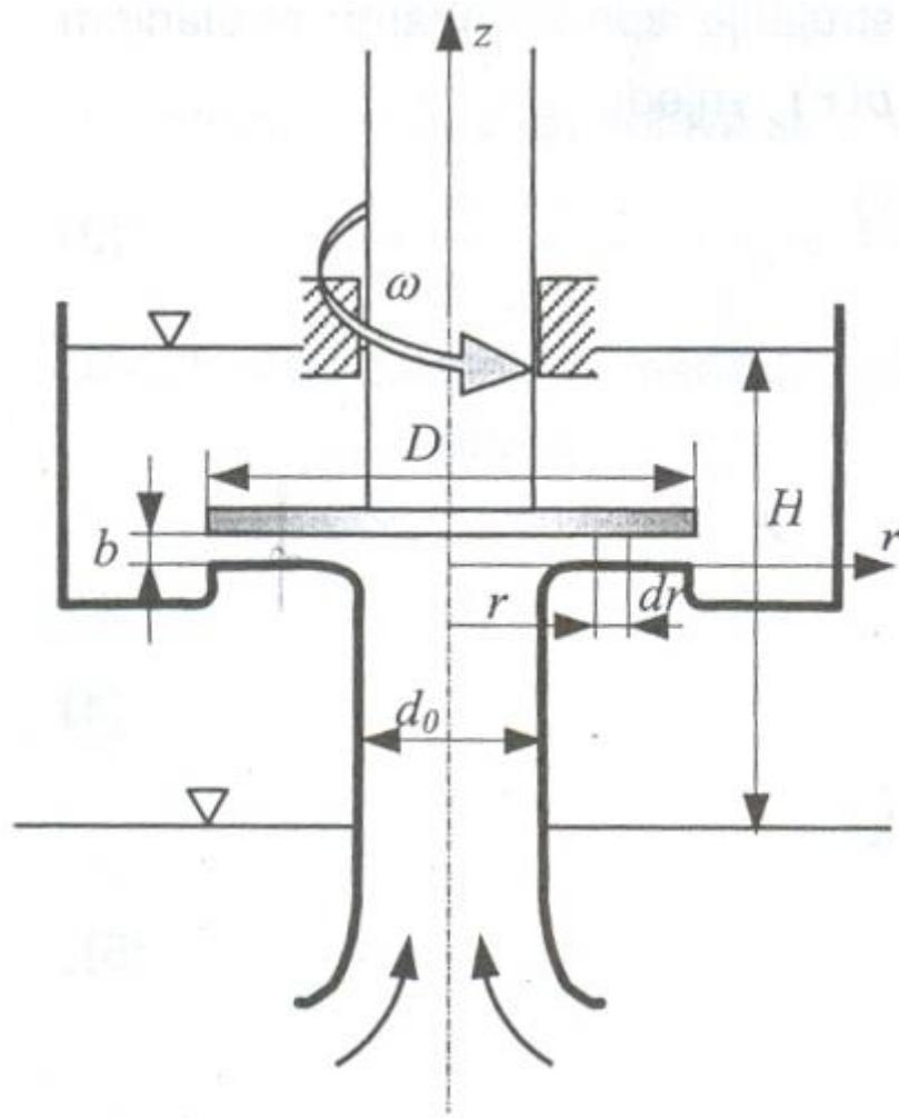
Slika 46. Shema frikcijske pumpe s rotirajućim diskom [29]
