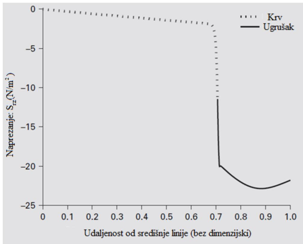
Slika 19. Predviđanje profila smičnog naprezanja krvni-ugruška 0.05s nakon primjene kriterija zamjene [14]
