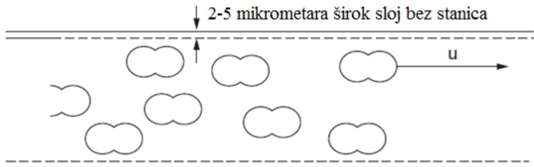
Slika 5. Strujanje eritrocita kroz cijev malog promjera [7]
