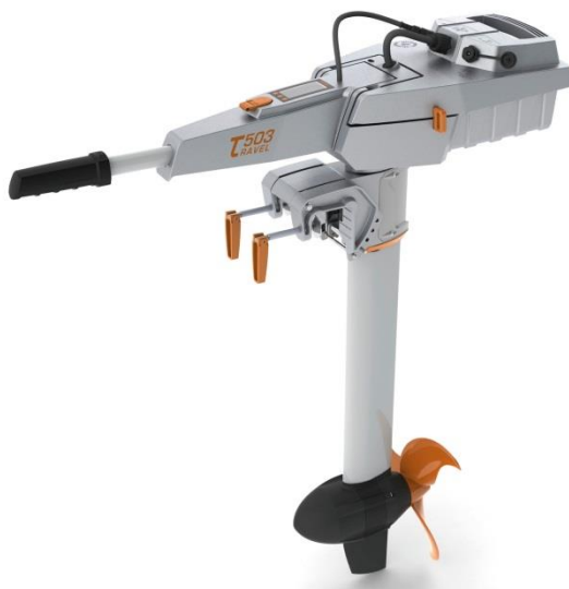
Slika 2. Vandbrodski električni motor pogon (lijevo) i propeler za pogon čamca (desno) [1]
