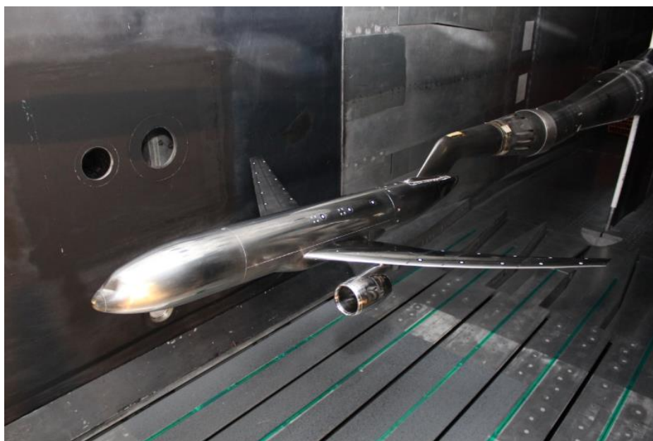
Slika 1.1: Stvarni model za eksperimentalna ispitivanja u zračnom tunelu [6]
