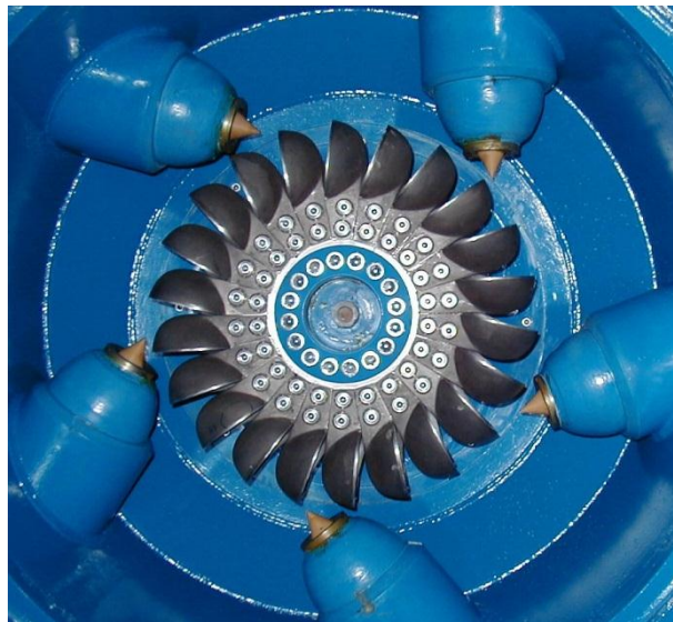
Slika 6: Pelton turbina sa mlaznicama i rotorom
