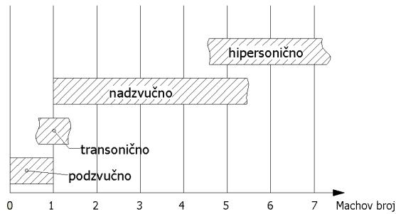
Slika 1.1: Klasifikacija strujanja prema brzini neporemećene struje
