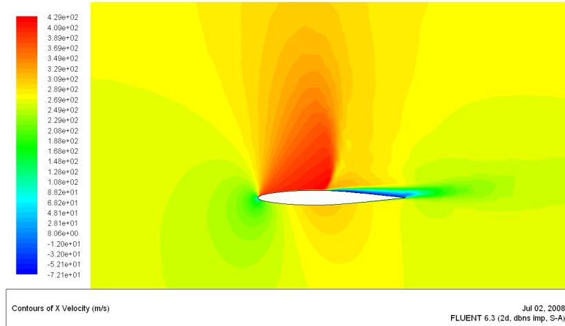
Slika 5.36: Konture  $V_x$  komponente brzine,  $M_\infty=0.789$ ,  $\alpha = 4^\circ$
