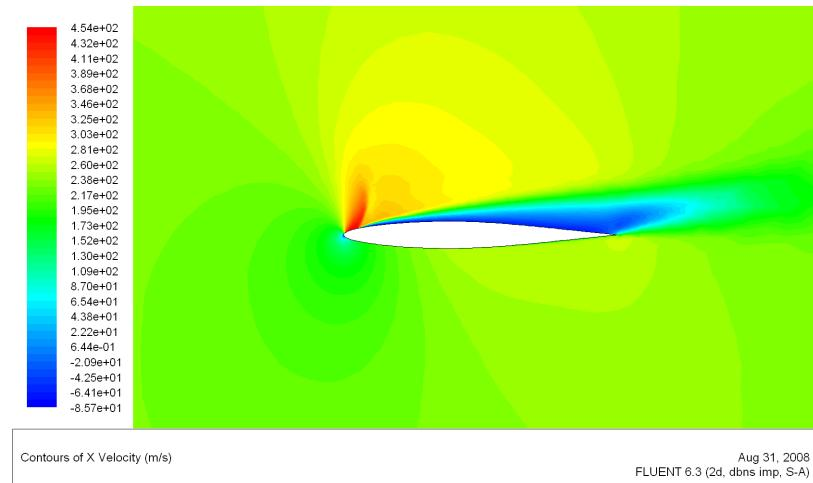
Slika 5.42: Konture  $V_x$  komponente brzine,  $M_\infty=0.7$ ,  $\alpha = 8^\circ$
