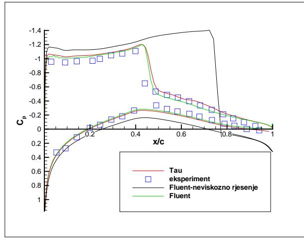
Slika 5.32:  $M_\infty=0.789$ ,  $\alpha = 4^\circ$ -usporedba koeficijenta tlaka  $C_p$  dobivenih mjerjenjem u zračnom tunelu [10], numeričkim kodom Fluent te numeričkim kodom TAU [11]
