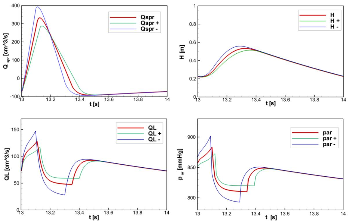
Slika 30. Variranje  $t_{ej}$ , 0.35 – crveno, 0.3, 0.4,  $t_1/t_{ej}$ =kont.
