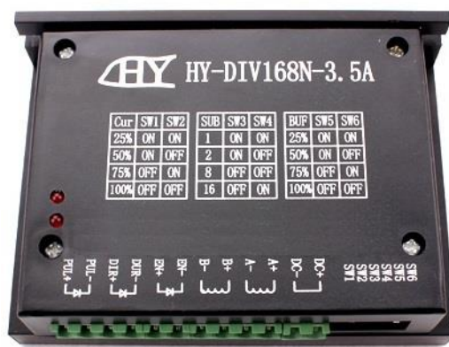
Slika 37. Driver koračnog motora HY-DIV168N-3.5A [31]
