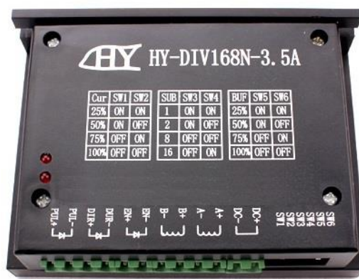
Slika 37. Driver koračnog motora HY-DIV168N-3.5A [31]
