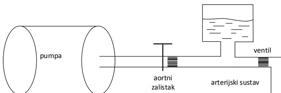
**Slika 8. Hidraulički ekvivalent Windkesselovom modelu sa 2 elementa**
