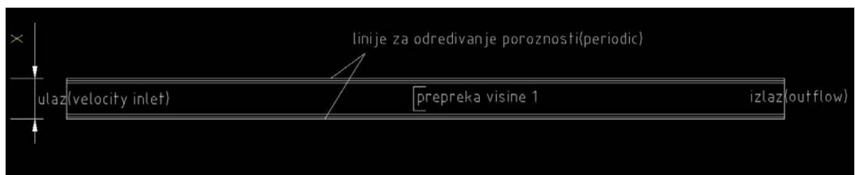
Slika 4.2 – Ispitivani profili i domena
