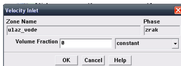
Slika 20: Definiranje rubnog uvjeta za sekundarnu fazu
