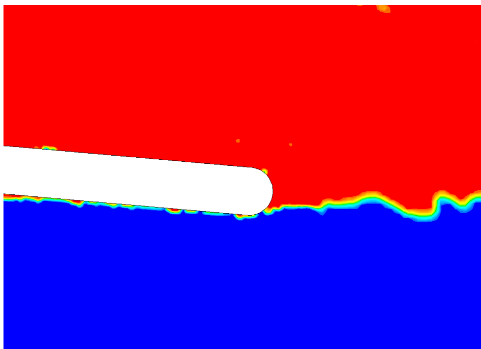
Slika 48: Uvećani dio slobodne površine u blizini zadnjeg dijela profila, ( \alpha = 5^\circ , D = 0.03 )
