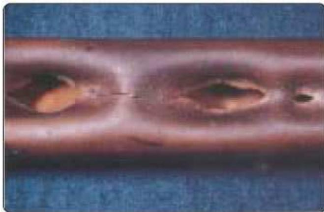
slika 1.1 – cijev oštećena hidrauličkim udarom
